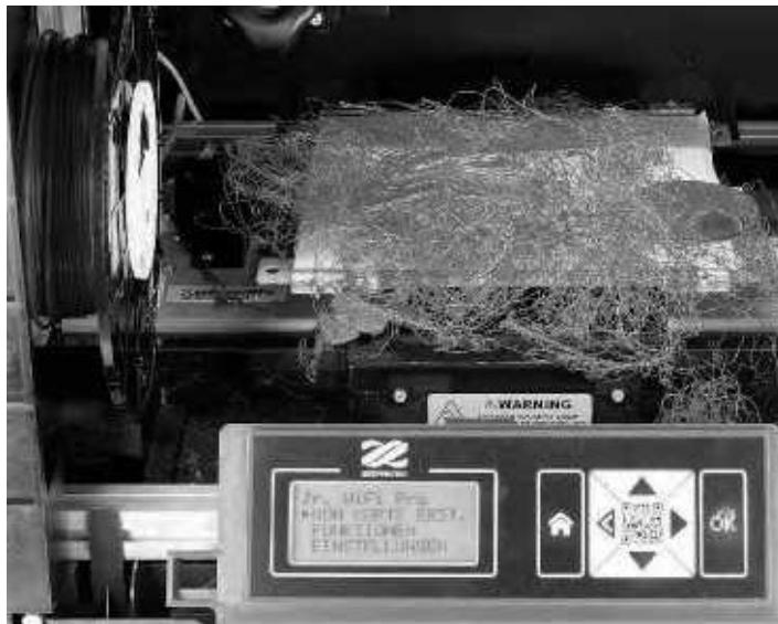
Schwer zu reinigen. Ein Fehldruck im XYZprinting Junior nach Verrutschen des Druckmusters. Viele Winkel und Ritzen im engen Gehäuse sind dann kaum noch sauber zu bekommen.
