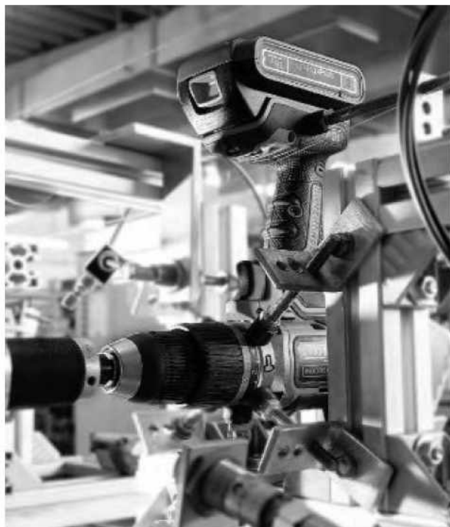
Auf dem Prüfstand. Mithilfe von Bohrschraubern wurde jeder Akku 200 Mal entladen.
