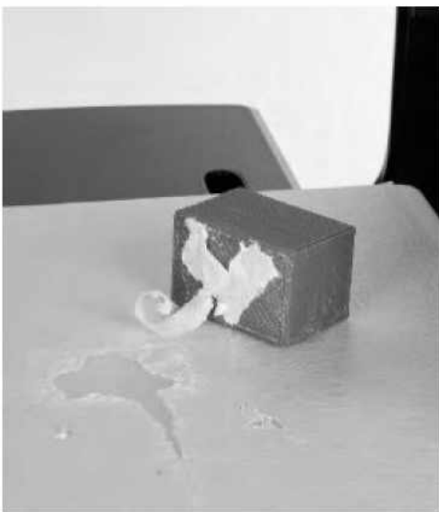
Verschleißartikel. Bei XYZprinting ist das Druckbett mit Krepppapier beklebt. Ein Verschleißartikel, wie man sieht.
