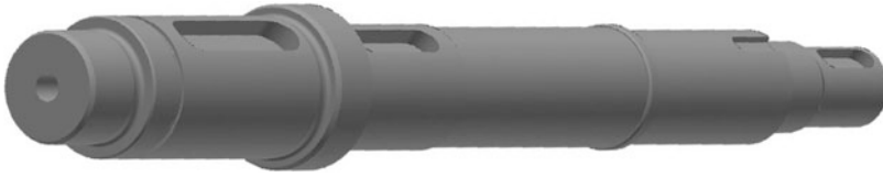
Abb. 4.5 Welle, Länge l = 200 mm, Äußerster Durchmesser \varnothing_{\max} = 40 mm
