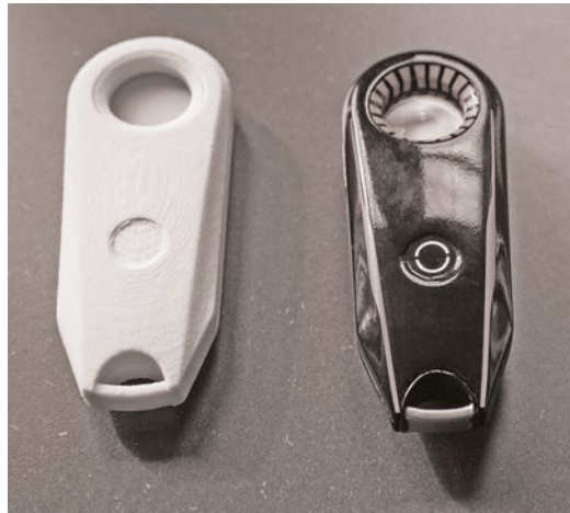
Abb. 9.1 Maßstabsgerechte Modelle eines Kfz-Schlüssels (Material: PA2200)
