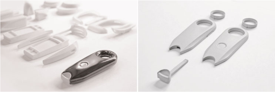
Abb. 9.1 Maßstabsgerechte Modelle eines Kfz-Schlüssels (Material: PA2200)
