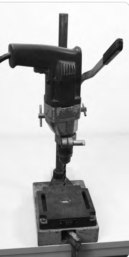
Eine Bohrmaschine samt Bohrmaschinenständer gehört zur Grundausstattung beim RepStrap-Bau. Als Befestigung am Tisch kann eine Schraubzwinge dienen.
