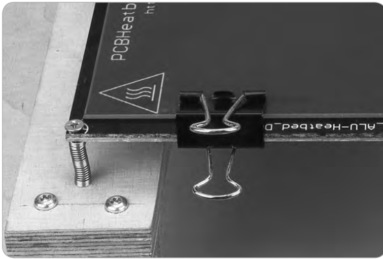
Folder-Klammern halten die Glasplatte auf dem Heizbett.
