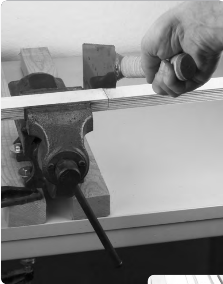
Eine Japansäge und ein Schraubstock in Aktion.
