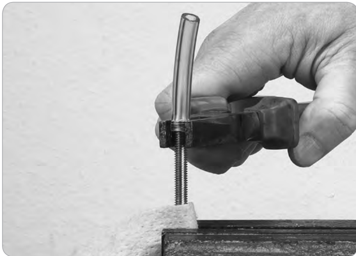
Eine provisorische Motorkupplung entsteht.
