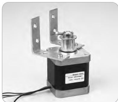
Zwei Stuhlwinkel dienen als preisgünstige Motorhalter.
