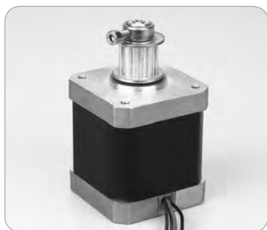
Zwischen Pulley und Motorgehäuse sollten Sie etwas Luft lassen.
