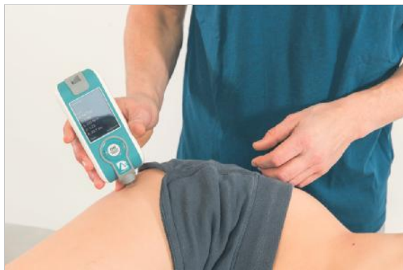
Abb. 30.2 Myoton. Das Myoton misst das Nachschwingverhalten des Gewebes, indem ein kurzer, mechanischer Impuls ins Gewebe gegeben und die folgende Resonanz gemessen und ausgewertet wird. Die unterschiedliche Schichtung von weichen und härteren Geweben ergibt jeweils charakteristische Schwingungskurven. Somit können mit dem Gerät auch tiefer liegende Spannungen gemessen werden.
