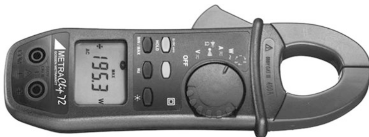
Abb. 11.11 Digitaler Leistungsmesser mit integrierter Stromzange (GMC-I Gossen-Metrawatt GmbH)
