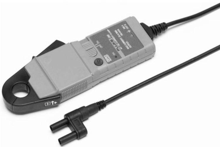
Abb. 7.5 Hallelement-Stromzange für Leiterströme bis 20 A, Empfindlichkeit 100 mV/A, Frequenzbereich DC bis 20 kHz (Fluke GmbH)
