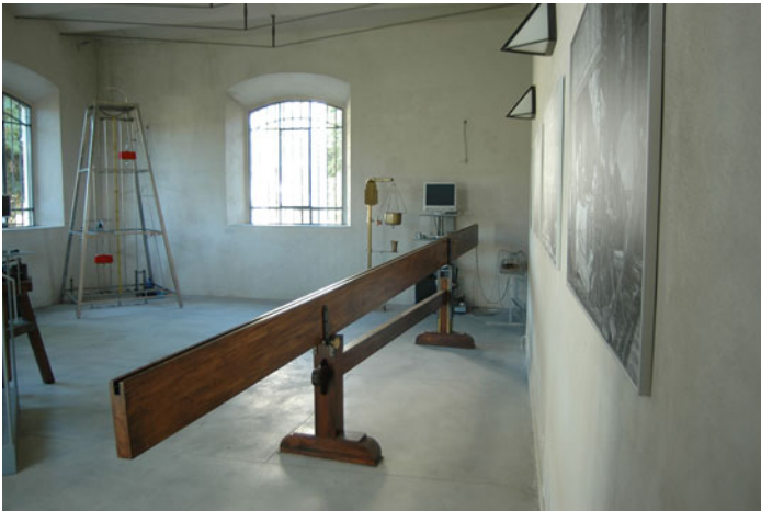
Abb. 1.3 Die Apparatur, die Galilei benutzte, um die beschleunigte Bewegung im Gravitationsfeld zu messen [VC09]. Eine direkte Messung des freien Falls konnte er nicht durchführen, da seine Uhr, wahrscheinlich ein Sekundenpendel, sowie die Reaktionsgeschwindigkeit zu langsam waren. Als Ausweg wählte er eine schiefe Ebene mit geringer Neigung, bei der die Geschwindigkeiten so langsam und die zu messenden Zeitintervalle so groß waren, dass er sie messen konnte. Um die Reibung zu minimieren, benutzte er eine Kugel, die von einer Rille an zwei Punkten geführt wurde, was links im Querschnittsbild zu sehen ist. Der einfache und effektive Aufbau dieser Apparatur bescheinigt Galileis experimentelle Genialität. Mit freundlicher Genehmigung von Roberto Vergara Caffarelli, „Galileo Galilei and Motion“
