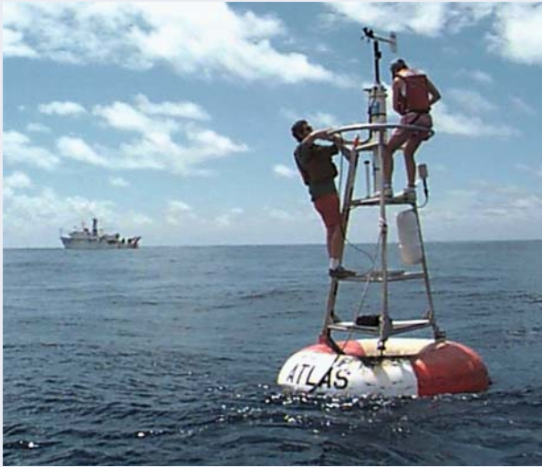
Wartungsarbeiten an einer Boje zur El-Niño-Vorhersage. © NOAA/ PMEL/TAO
