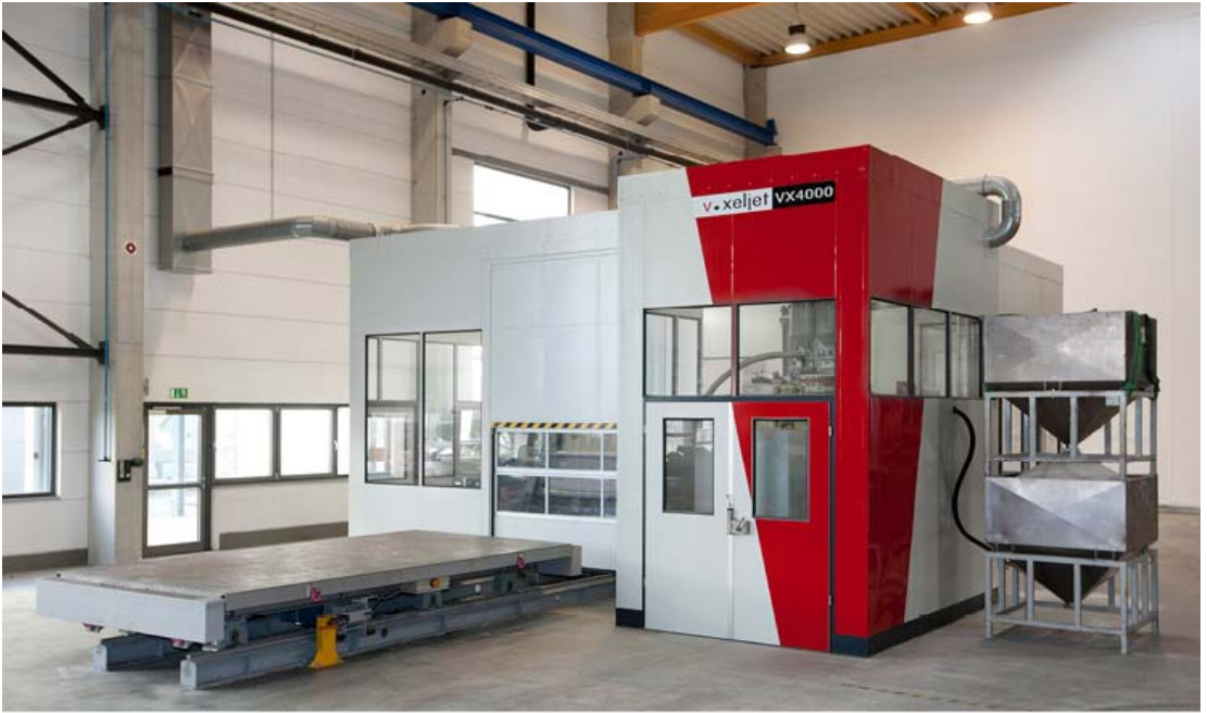
Bild 3.20 VX4000 – einer der größten 3D-Drucker der Welt: Das Druckbett fährt die tonnenschweren Drucke auf Schienen aus der Maschine (Foto: © voxeljet AG).
