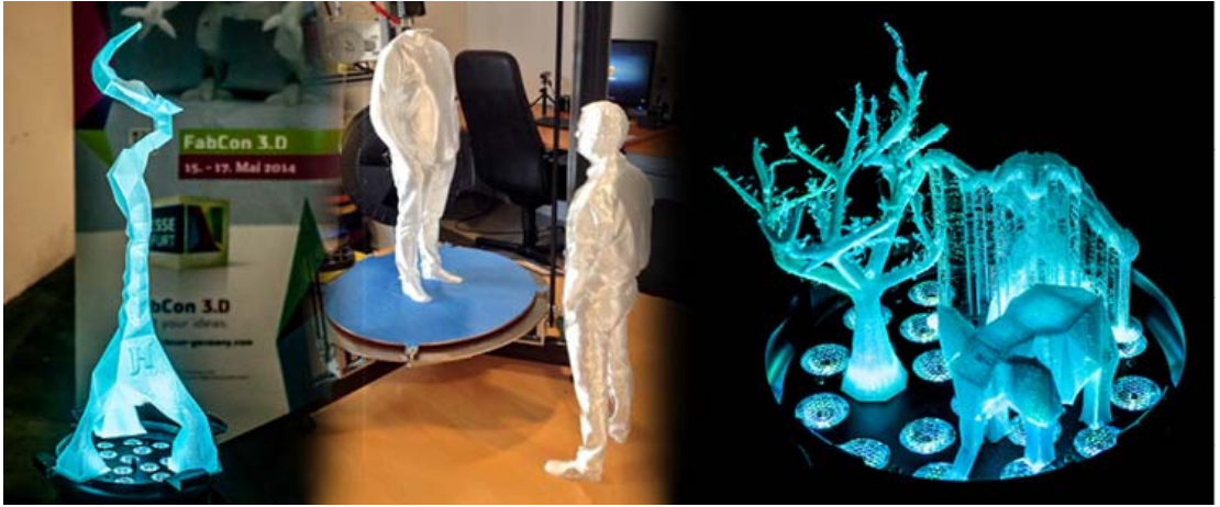
Bild 4.61 colorFabb_XT – dem transparenten Material wird eine große Zukunft im 3D-Druck vorausgesagt (Foto in der Mitte: Sander Strijbos und Ruud Rouleaux, © colorFabb)
