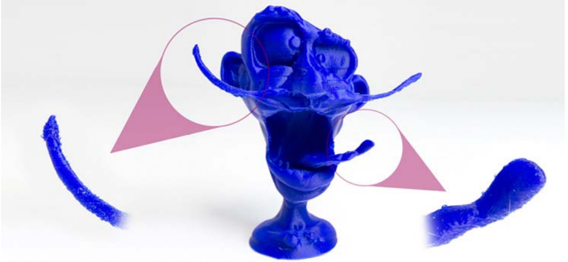
Bild 4.40 Der Bart steht! Extreme Überhänge sind durch sehr dünne Schichten zu meistern (Foto: © Marrit Hoffmans, Quelle des Modells: Sander van Geelen, https://www.youmagine.com/designs/moustache-man [19bJ7Fv]).
