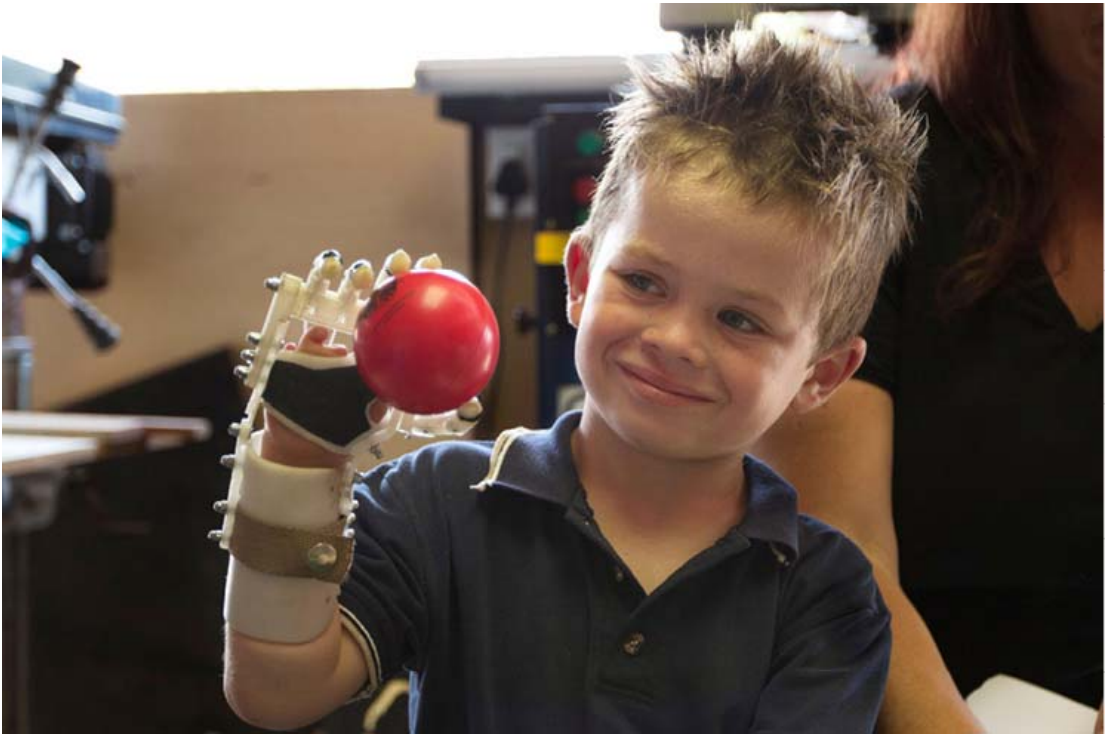
Bild 2.12 Die Robohand, eine 3D-druckbare Handprothese von Richard van As und Ivan Owen (Quelle: http://www.thingiverse.com/thing:44150 [1faVHev])
