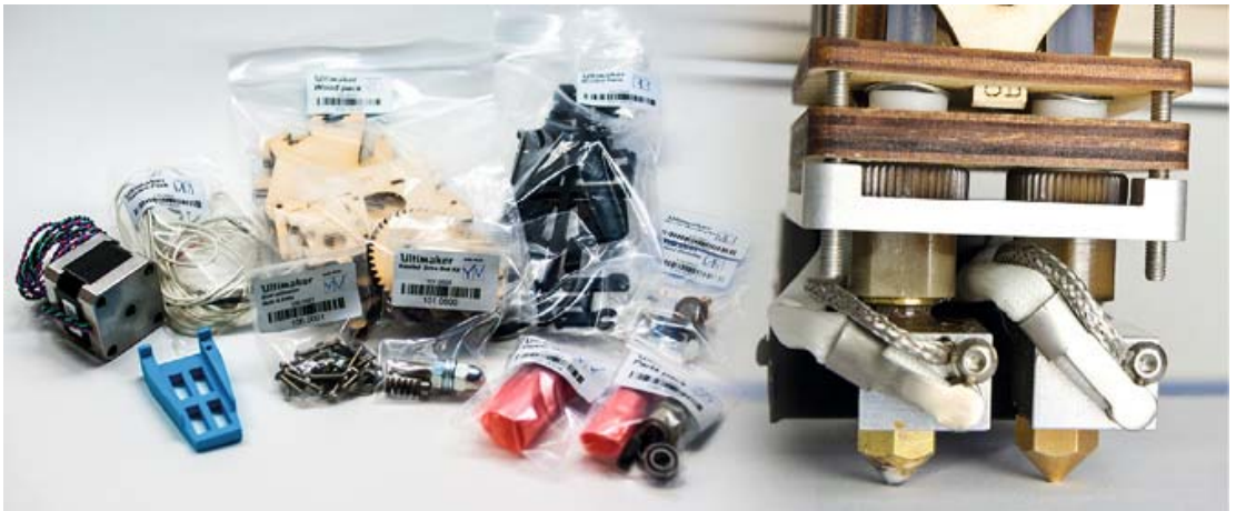
Bild 5.45 Das Ultimaker Dual Extrusion Upgrade Kit (links) und die Nivellierung der beiden verbauten Düsen (rechts). (Foto rechts: © Ultimaking Ltd.)
