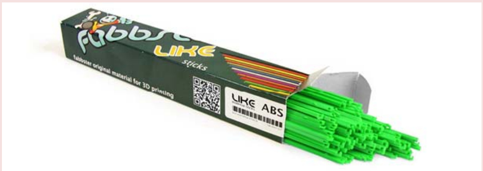
Bild 4.4 Das LIKE ABS-Material für den 3D-Drucker Fabbster ist in Form von Sticks erhältlich (Foto: © Creative Tools/ http://www.creativetools.se/ ).
