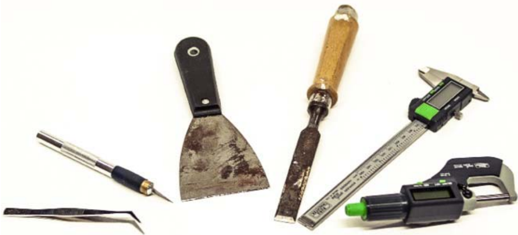
Bild 4.63 Meine Lieblings-Werkzeugauswahl (von links nach rechts): Pinzette, Bastelmesser, Spachtel, Stemmeisen, Messschieber und Mikrometerschraube
