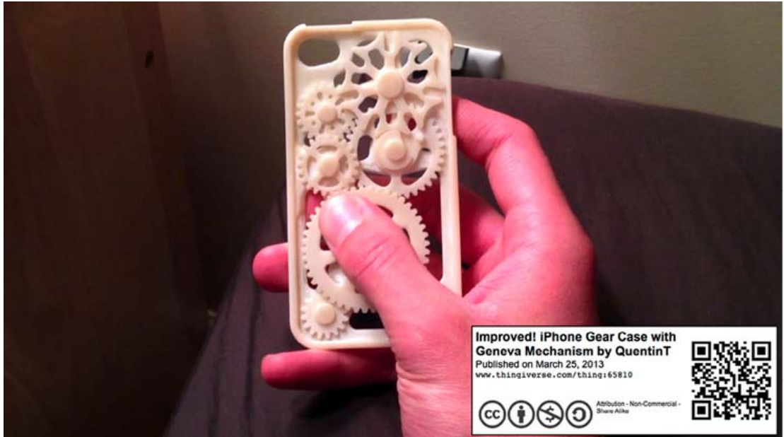
Bild 2.9 Das voll bewegliche iPhone Gear Case von Quentin Torgerson (Quelle: http://www.thingiverse.com/thing:65810 [18HRZUI])
