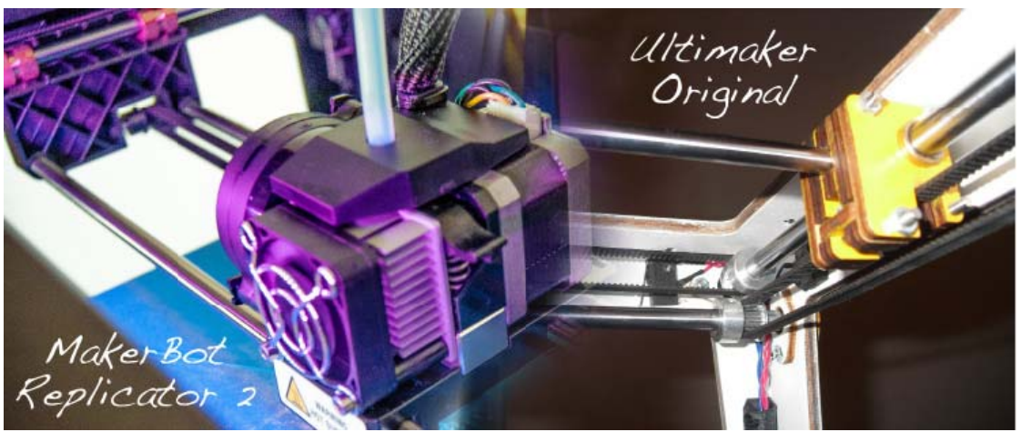
Bild 4.9 Verschiedene Ansätze: Der getrennte X/Y-Aufbau des MakerBot Replicator 2 im Vergleich zum kombinierten Aufbau des Ultimaker Original
