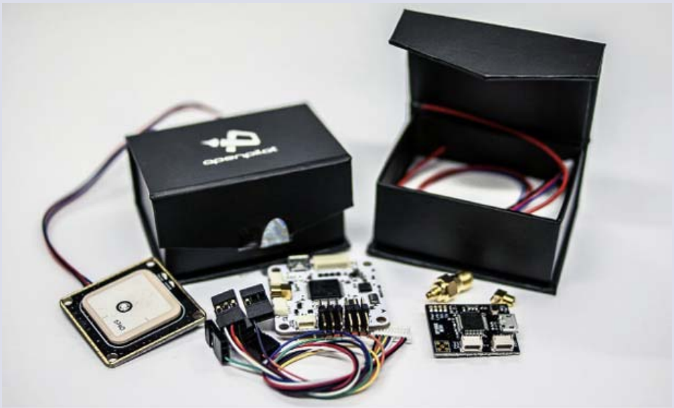
Bild 5.35 Eine Revolution in der Multicopter-Szene – OpenPilot V8 GPS, Revolution Flight Controller und die Funkverbindung OPLink (von links nach rechts).
