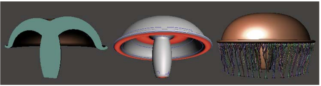
Bild 1.17 links: Pilz im Querschnitt, Mitte: Überhänge in Rot markiert, rechts: Supportstrukturen, die den Pilz stützen
