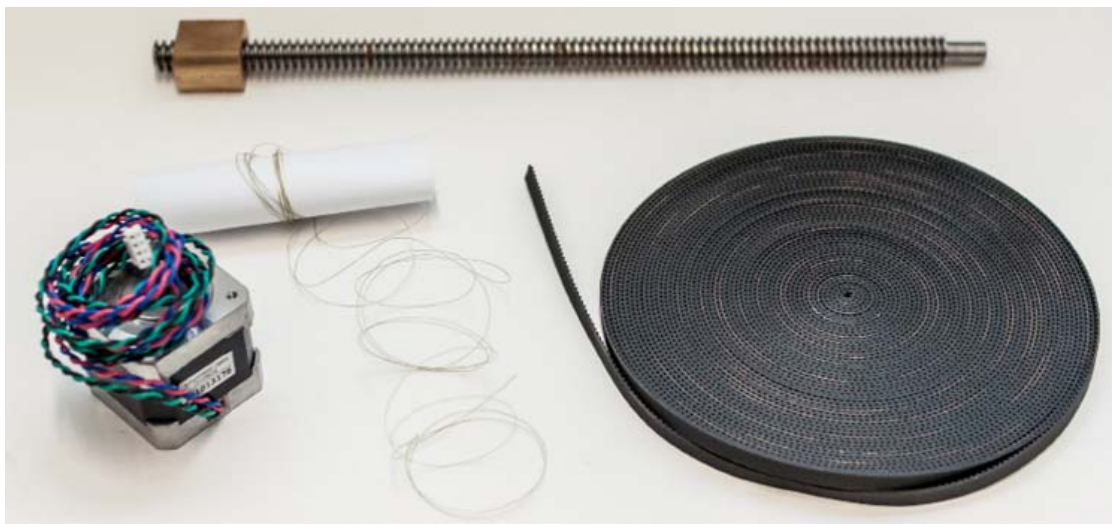
Bild 4.11 Von links nach rechts: Schrittmotor, Angelschnur, Antriebsspindel und Riemen
