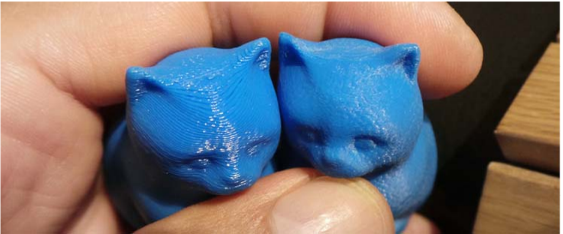
Bild 4.39 Der Treppenstufeneffekt – deutlich zu sehen auf Schrägen und Rundungen (Foto: © Creative Tools, Quelle des Modells: www.thingiverse.com/thing:146265 [1e5wrml])
