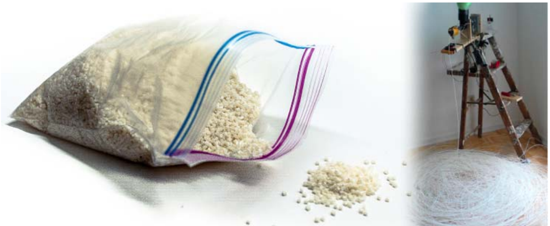
Bild 5.48 Vom Granulat zum fertigen Filament ist es nur ein kleiner Schritt (Foto rechts: © David Campbell/supraflyer).
