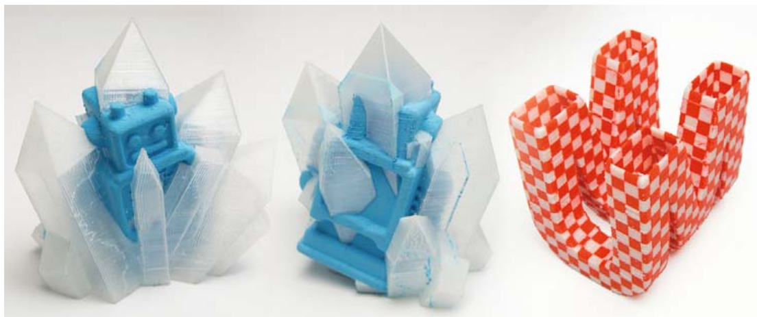
Bild 5.46 Eine ungünstige Materialwahl lässt kleine Farbausläufe (Mitte) deutlich sichtbar werden. Anspruchsvolle Testdrucke (rechts) zeigen die schnellen Fortschritte in der Entwicklung 402 (Fotos: © Marrit Hoffmans/Ultimaking Ltd.).
