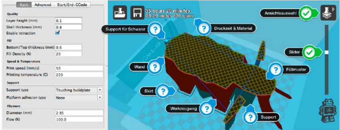
Bild 4.53 Enttäuschungen vorbeugen: Die Schichtansicht ist ein tolles Werkzeug, um vor dem Druckstart Probleme in Cura zu erkennen.
