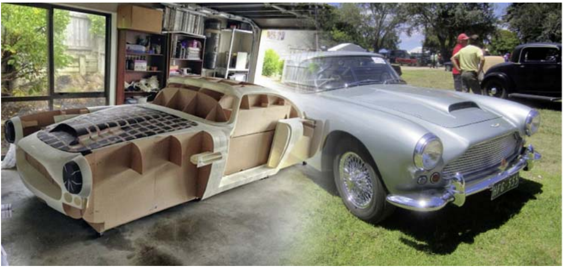
Bild 1.38 Ivan Sentch träumt von einem eigenen Aston Martin DB4 und druckt sich deshalb 2500 perfekt geformte Kacheln, aus denen er in einem weiteren Schritt die Karosserie nachbaut. Den aktuellen Fortschritt können Sie unter http://www.replicadb4.com/ nachlesen (Foto links: © Ivan Sentch, Foto rechts: © flickr.com, User: Sicnag).
