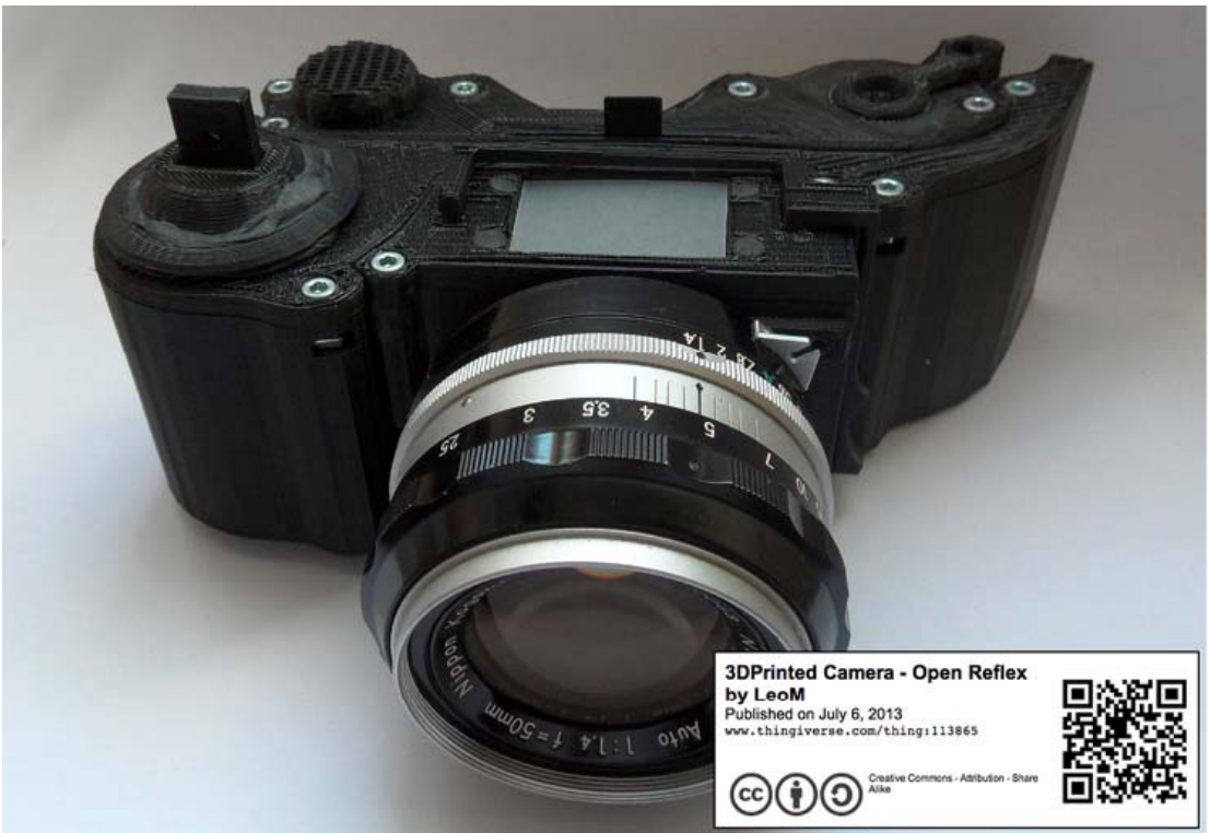
Bild 2.11 Die voll funktionsfähige Analogkamera Open Reflex von Léo Marius 60 (Quelle: http://www.thingiverse.com/thing:113865 [16MZBHS])
