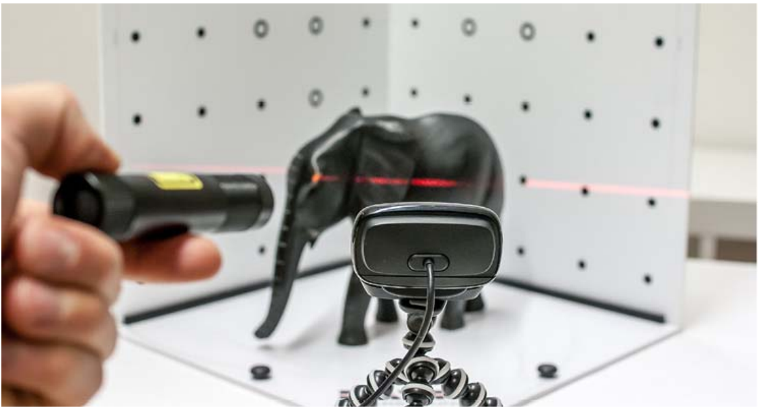
Bild 2.42 Das DAVID-Laserscanner-Starter-Kit (Version 2) im Einsatz
