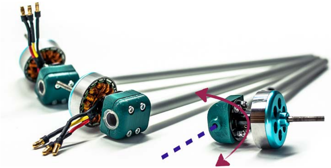
Bild 5.32 Egal welchen Motor Sie kaufen – durch die ausgedruckten Motorhalterungen wird er immer perfekt passen. Der Heckmotor kann sich auf der Achse drehen.
