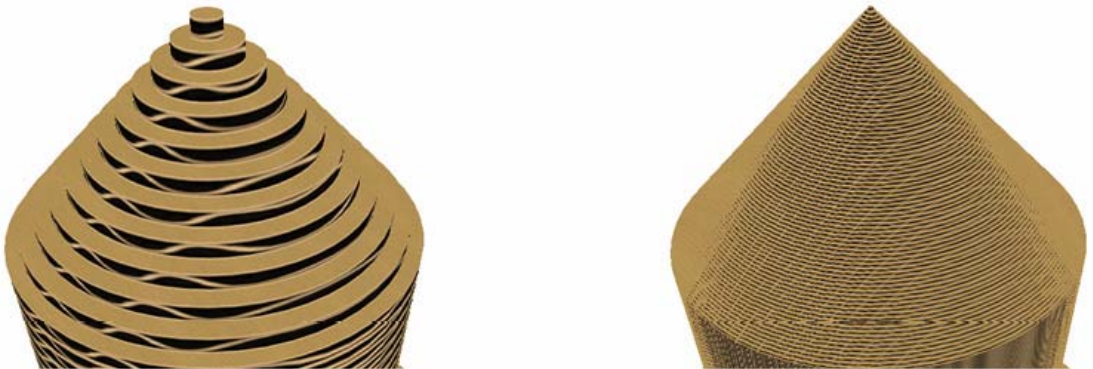
Bild 1.18 rechts: 0,05 mm Schichthöhe, links: Der Treppenstufeneffekt ist klar zu erkennen (0,35 mm Schichthöhe).
