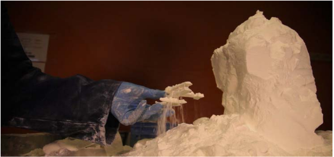
Bild 3.12 Ein Druck wird aus dem Pulverkuchen entnommen (Foto: © Shapeways Inc.).
