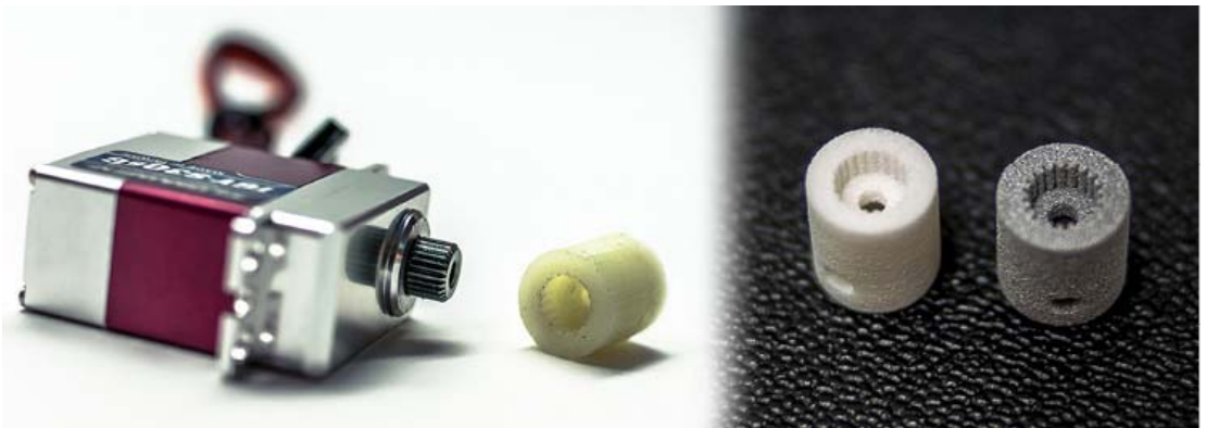
Bild 5.33 Detailarbeit: Selbst die winzig kleinen Zähne des Servo-Adapters meisterte der FDM-Drucker (links). Rechts sehen Sie im Vergleich das gleiche Teil aus Polyamide bzw. Alumide, die aus der SLS-Fertigung eines Dienstleisters stammen.
