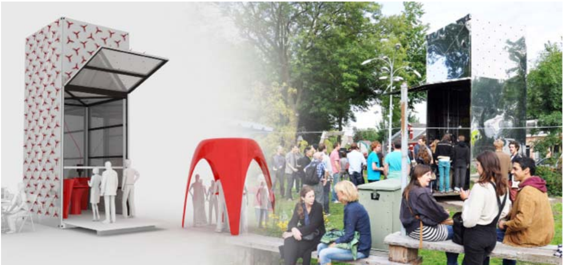
Bild 1.35 Von der Vision zum fertigen Drucker: Mit der Größe eines Seefrachtcontainers zählt der Kamermaker ( http://www.kamermaker.com/ ) zu einem der größten 3D-Drucker der Welt (© DUS Architects).
