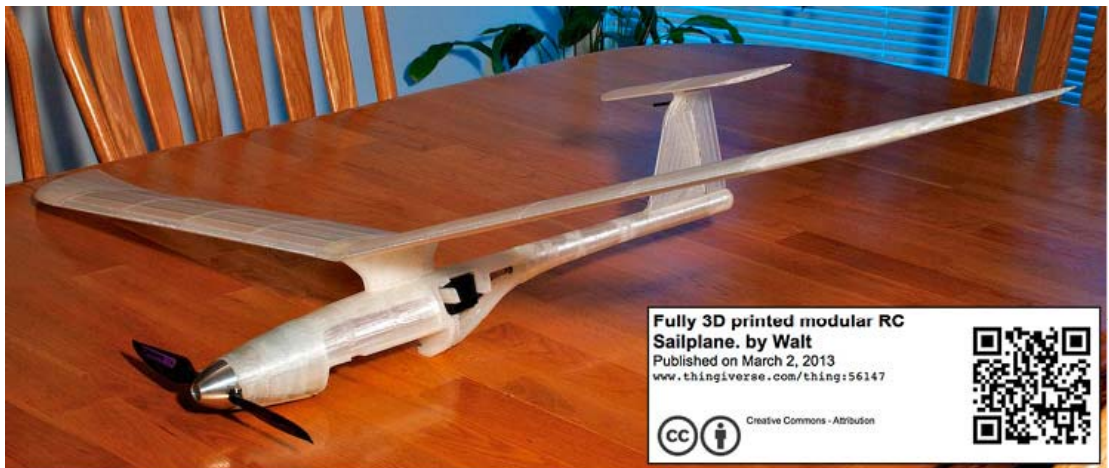
Bild 2.10 Ein 28-teiliges ferngesteuertes Segelflugzeug von Walt (Quelle: http://www.thingiverse.com/thing:56147 [GCUU77])
