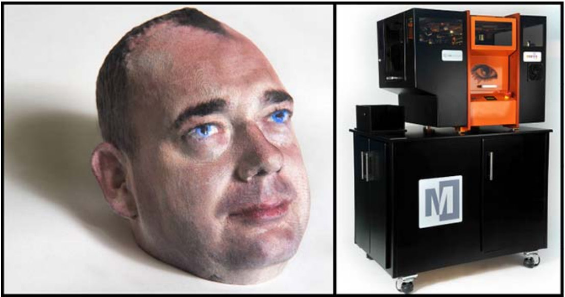
Bild 3.31 Der 3D-Drucker Mcor IRIS liefert vollfarbige Ausdrücke (Foto: © Mcor Technologies Ltd.).
