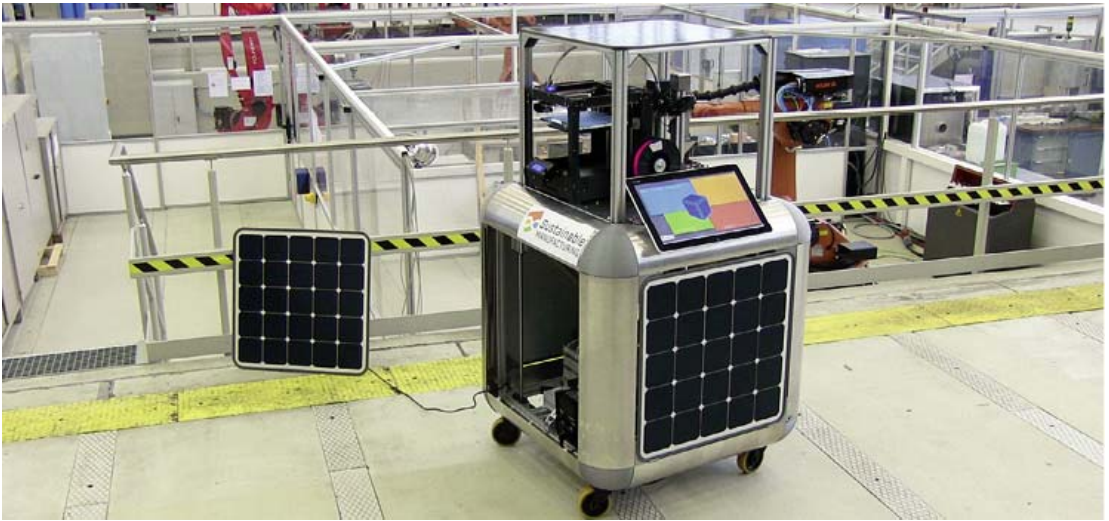
Bild 1.45 Die Open Source Cube Factory ist eine mobile und in sich geschlossene Mini-Fabrik mit eigener Stromversorgung. Nähere Informationen zur Recycling-Einheit und zum 3D-Drucker finden Sie unter http://cubefactory.org/ (Foto: © Bernd Muschard & Sharmaine Mannan).
