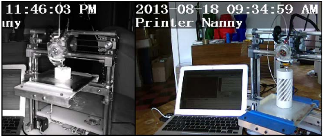
Bild 4.68 Eine netzwerksteuerbare Webcam mit Nachtsichtmodus macht einem die Überwachung leicht.
