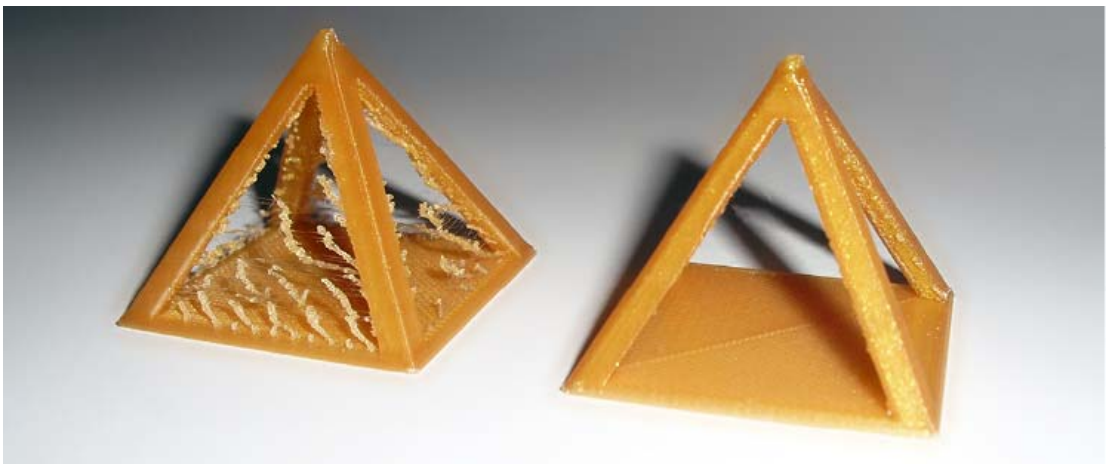
Bild 4.43 Ein Unterschied wie Tag und Nacht: Eine Testpyramide ohne (links) und mit (rechts) Retraction (Quelle des Modells: http://www.thingiverse.com/thing:11846 [1b6aVMZ])
