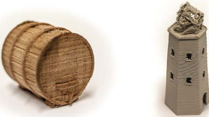
Bild 4.60 Die innovativen Materialkreationen von Dipl.-Ing. Kai Parthy: Laywoo-D3 (links) und Laybrick (rechts); Quelle des Modells (rechts): http://www.thingiverse.com/thing:19786 [GOFsVI]
