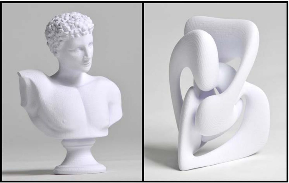
Bild 3.32 links: Steile Überhänge sind im LOM-Verfahren kein Problem, rechts: Verschlungene Geometrien werden nur zum Problem, wenn das Restmaterial nicht mehr entfernbar ist (Foto: © Mcor Technologies Ltd.).
