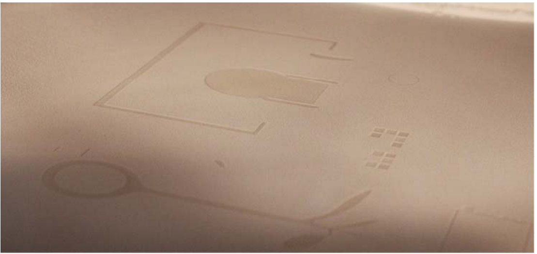
Bild 3.10 Schattenhaft sind die gesinterten Bereiche einer Schicht zu erkennen (Foto: © scope for design).
