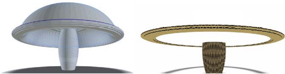
Bild 1.16 Die Überhangsproblematik: Wo soll sich der Schirm des Pilzes aufstützen?
