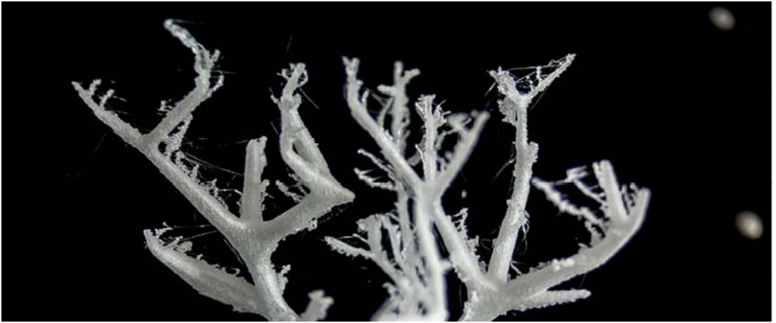
Bild 4.70 Normalerweise würde man sich über die Fädenbildung ärgern – gut, dass sie in diesem Fall wie kleine Äste aussehen! (Modell: © Ulrike Hemmann)
