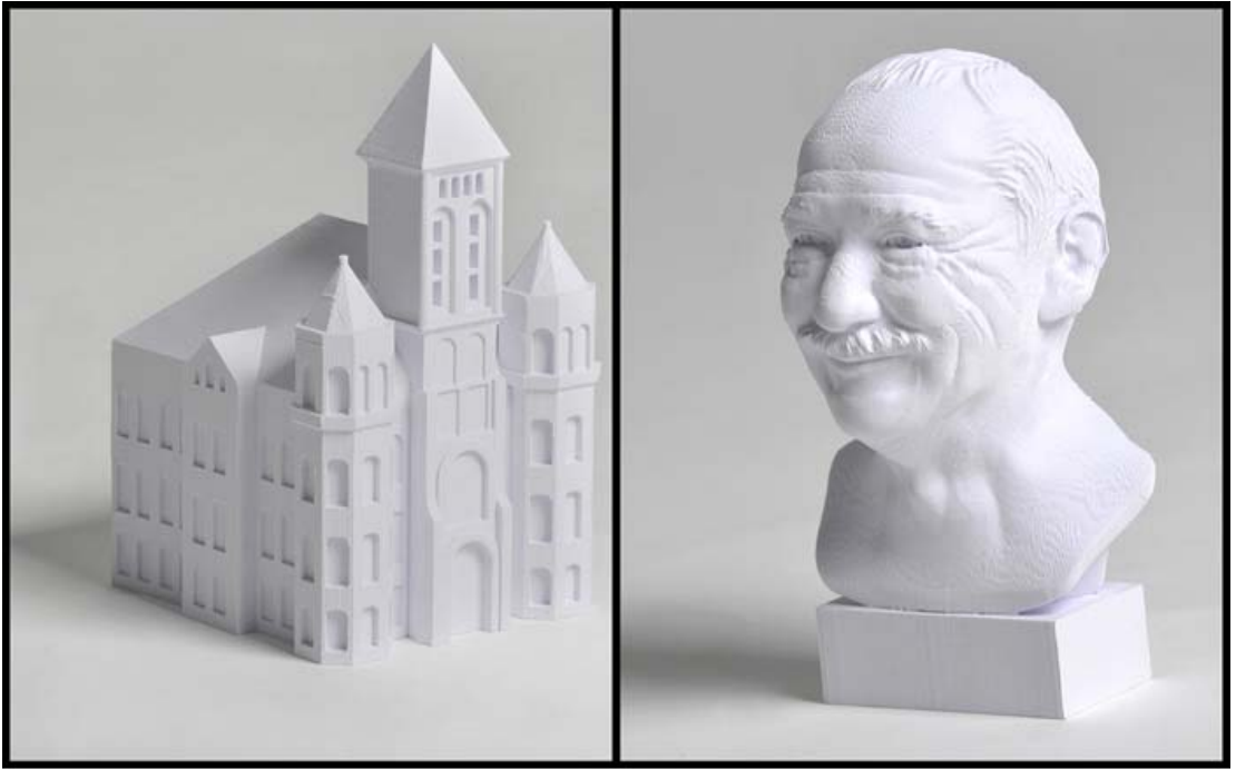
Bild 3.33 Beeindruckende Details, aber die einzelnen Schichten sind stellenweise stark sichtbar (Foto: © Mcor Technologies Ltd.)
