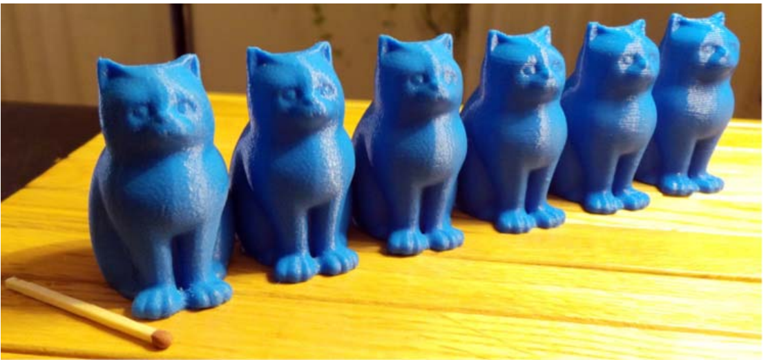
Bild 4.38 Katzenparade (von links nach rechts): 20, 50, 100, 200, 300, 400 Mikrometer ( \mu\text{m} ) Schichthöhe (Foto: © Creative Tools, Quelle des Modells: www.thingiverse.com/thing:146265 [1e5wrml])
