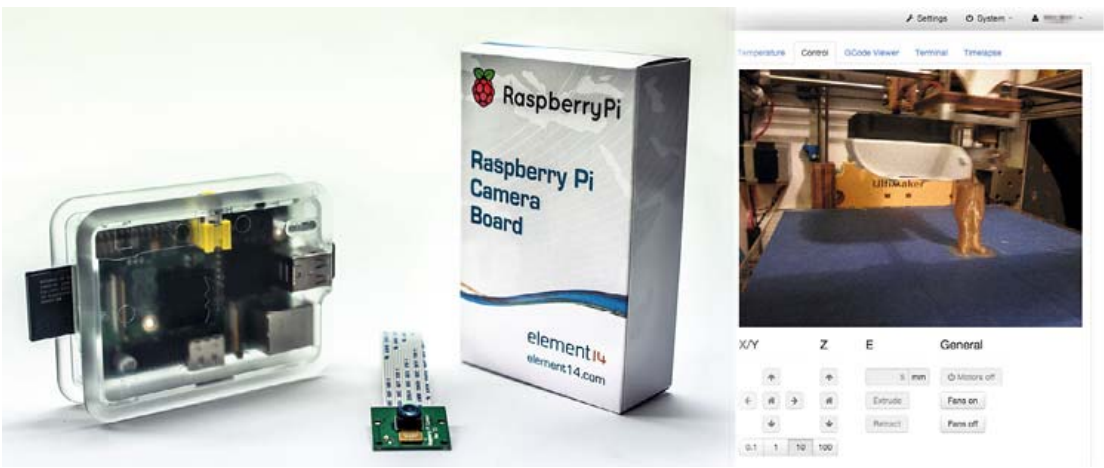
Bild 5.37 Eine alte Webcam oder die spezielle Raspberry Pi-Kamera (kleine Platine in der Mitte des Bildes) ermöglichen es Ihnen, den Drucker auch visuell im Auge zu behalten. 389
