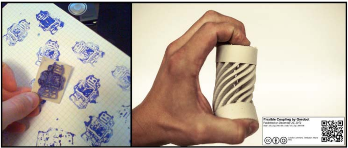
Bild 4.59 PLA soft im Einsatz – in der flexiblen Kupplung von Steve Wood (Quelle: http://www.thingiverse.com/thing:38678 [GKp8F2])
