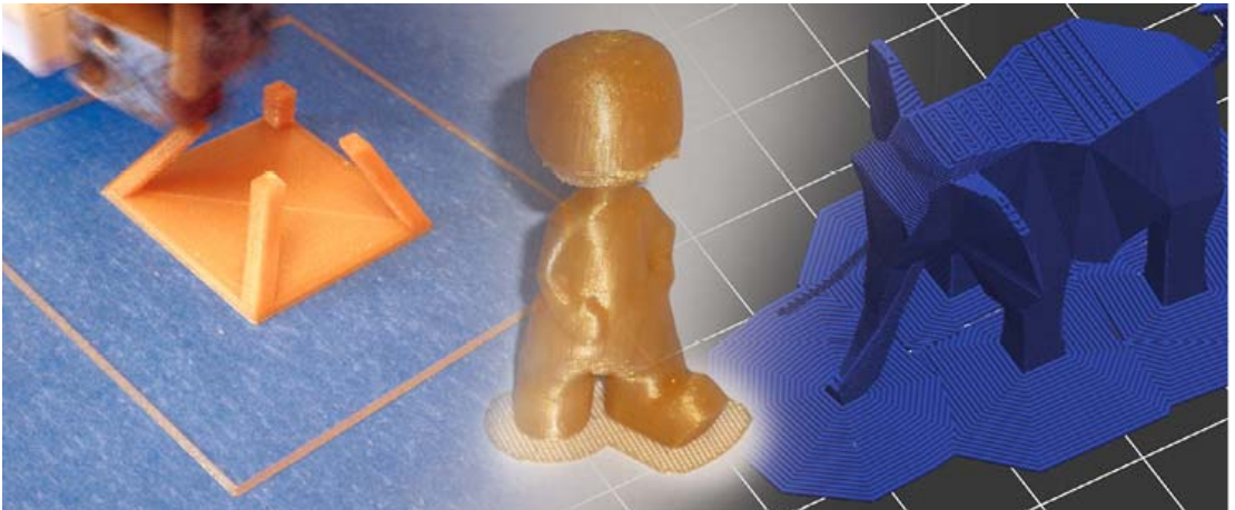
Bild 4.44 Drei praktische Helferlein: Skirt (links), Raft (Mitte) und Brim (rechts)
