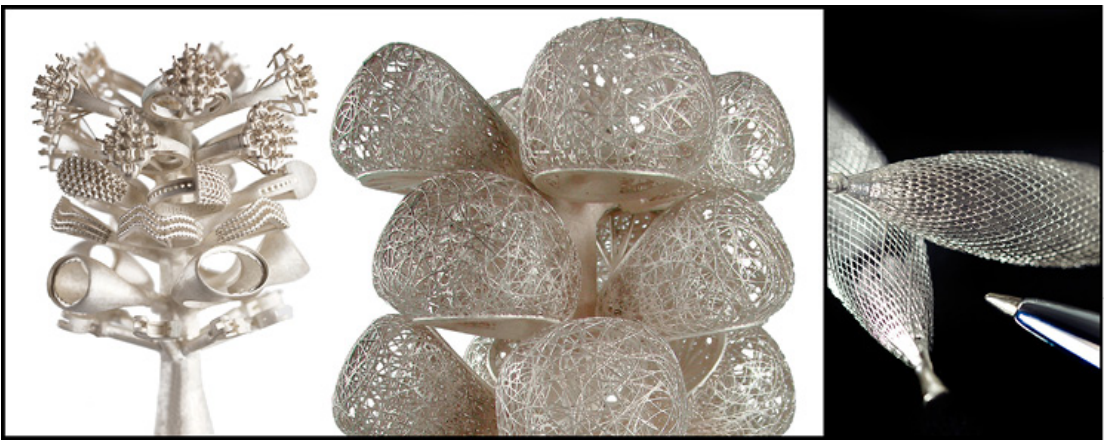
Bild 3.45 Ergebnis des Wachsaußschmelzverfahrens – ein Baum voller Schmuck: Selbst filigranste Strukturen sind möglich (Foto: © DWS 193 ).
