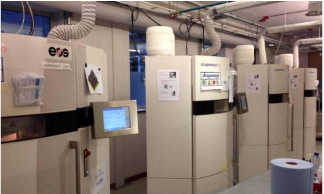
Bild 3.35 Einblicke in die Fabrik der Zukunft: Vier SLS-Anlagen im Einsatz (Foto: © Shapeways Inc.)
