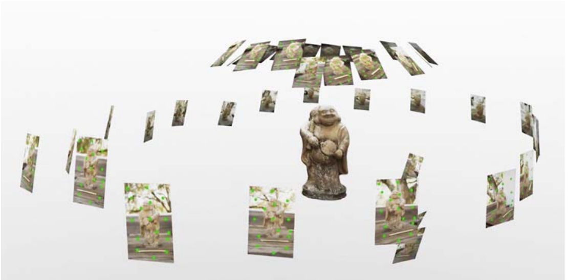
Bild 2.37 Autodesk 123D Catch: Zusammengesetzte Fotos ergeben ein druckbares 3D-Modell (Quelle: http://www.123dapp.com/howto/catch [18HWnCO]).
