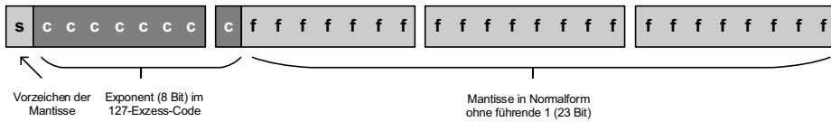
Abb. 1.14 Aufbau einer kurzen Gleitkommazahl nach dem IEEE 754 Standard
