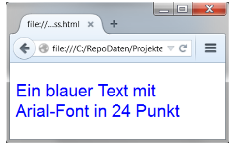
Abb. 17.7 Verwendung von CSS innerhalb eines HTML Dokuments
