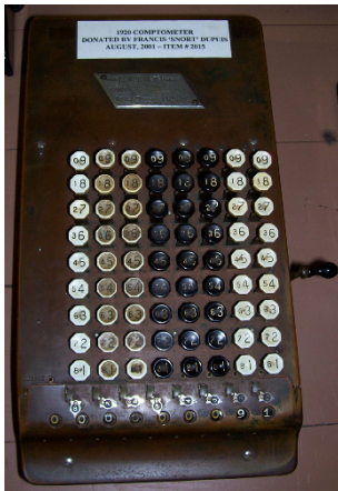
Abb. 1.11 Ein Comptometer von 1920. Gerechnet wird zur Basis 10 im Zehnerkomplement, die Eingabe der Zahlen erfolgt im 9-Komplement. Damit das Ergebnis stimmt, muss bei der Eingabe negativer Zahlen vor der Komplementbildung im Kopf eine Eins subtrahiert werden, was der Bildung des 10-Komplements der ursprünglichen Zahl entspricht. Jede Ziffernreihe gehört zu einer Dezimalstelle; diese können durch gleichzeitiges Drücken parallel eingegeben werden. Aus mechanischer Sicht ist die Verwendung des Komplements interessant, da keine rückwärts laufenden Zahnräder benötigt werden.
