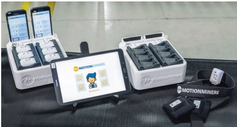
Abb. 4.7 MotionMiners: Hardware-Ausrüstung für die Prozessmessung
