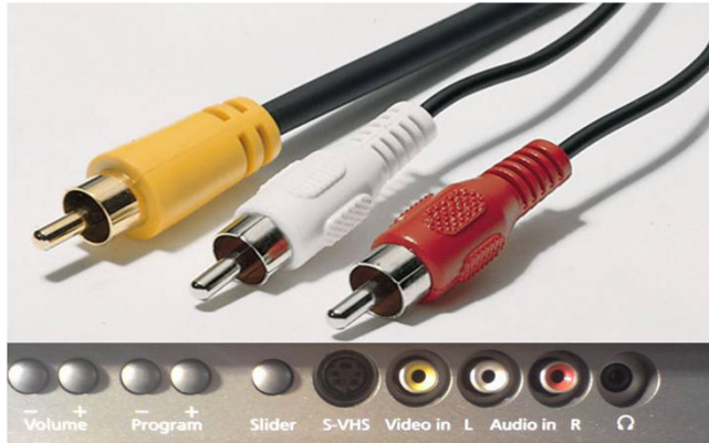
Bild 3-21 Verwendung von Farben an Bauteilen zur Reduzierung der Verwechslungsgefahr
