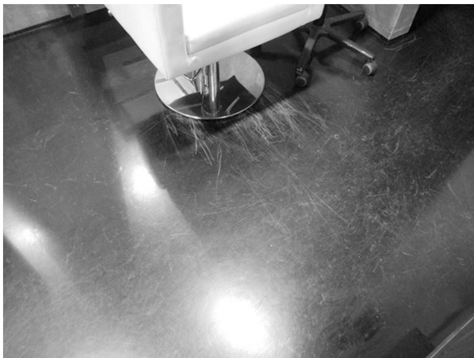
Abb. 1.4 Kratzer mit Weißbruch in einer schwarzen Hochglanzbeschichtung
