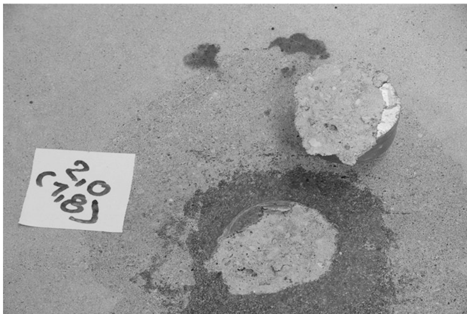
Abb. 6.5 Prüfung der Oberflächenzugfestigkeit an einer vorbereiteten Estrichoberfläche
