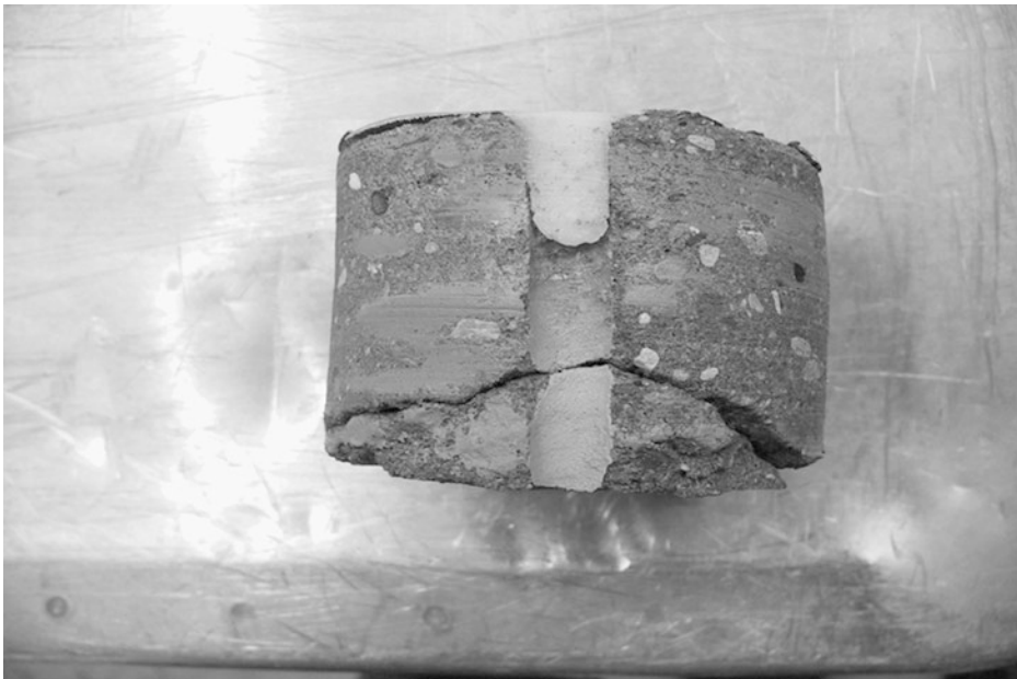
Abb. 2.11 Hier sollte eine Hohllage mit einem Reaktionsharz hinterfüllt werden, jedoch hat das Harz nur das Bohrloch verschlossen und die Hohllage nicht erreicht
