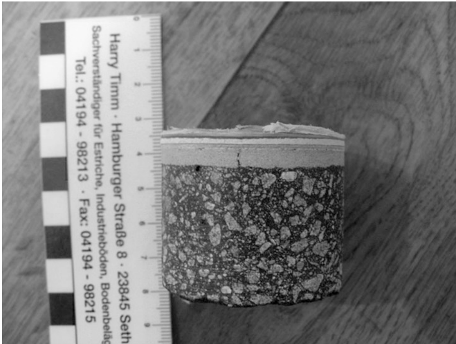
Abb. 12.9 Die Ursache der Streifen waren Rissbildungen in der zementären Spachtelmasse
