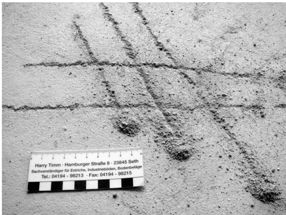
Abb. 6.7 Ritzbild, das mit Sicherheit einen mechanischen Abtrag der labilen Zone erfordert
