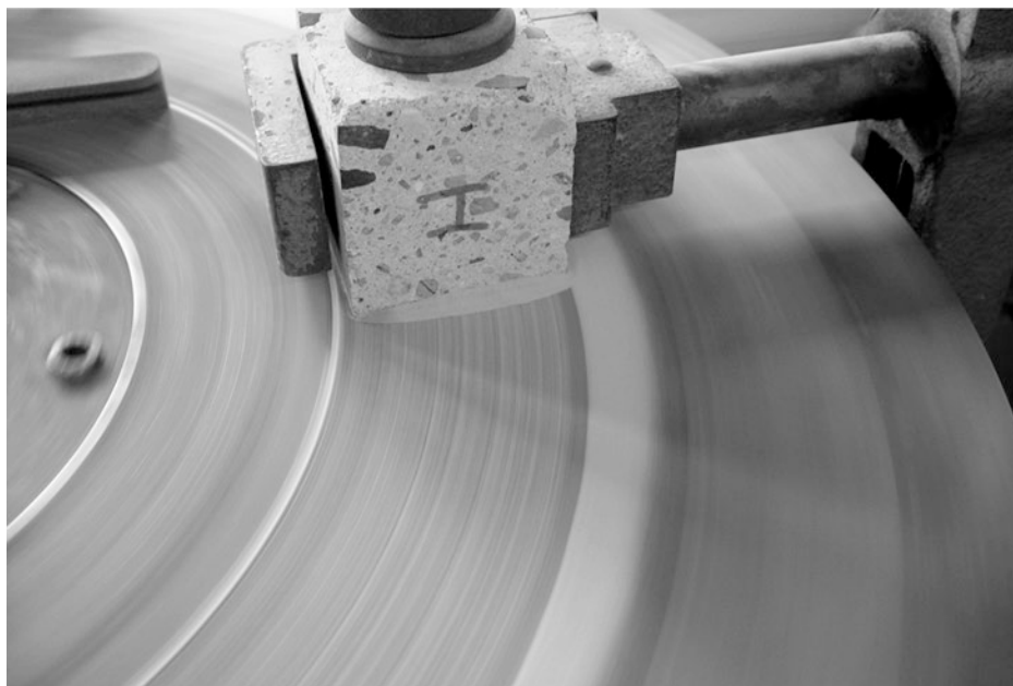
Abb. 6.4 Ein Prüfkörper auf der rotierenden Stahlscheibe (Böhmische Scheibe) mit Schleifmittel (Hansa-Nord-Labor, Pinneberg)
