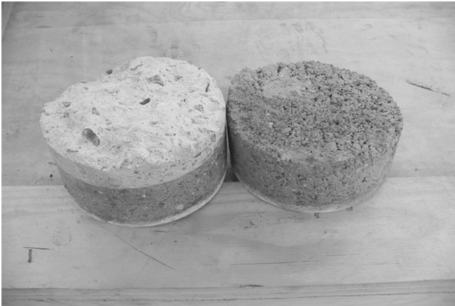
Abb. 2.10 Innerhalb einer Fläche ein ausgezeichneter Verbund mit Bruch ca. 20 mm tief im Beton (links) und eine Hohlage wegen einer fehlerhaft hergestellten Haftbrücke (rechts)
