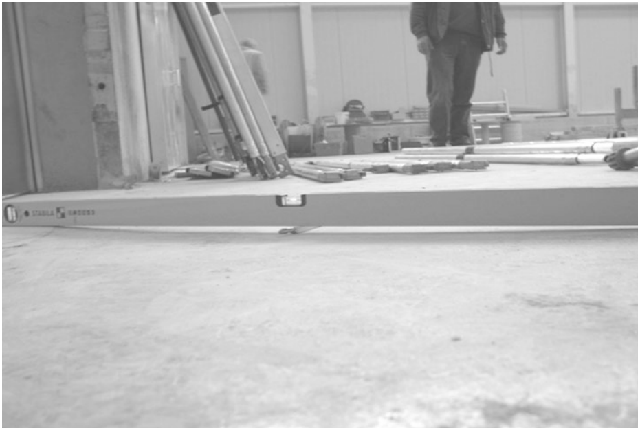
Abb. 6.15 Prinzip der Messung mit Messlatte und Messkeil (hier unter der Libelle)
