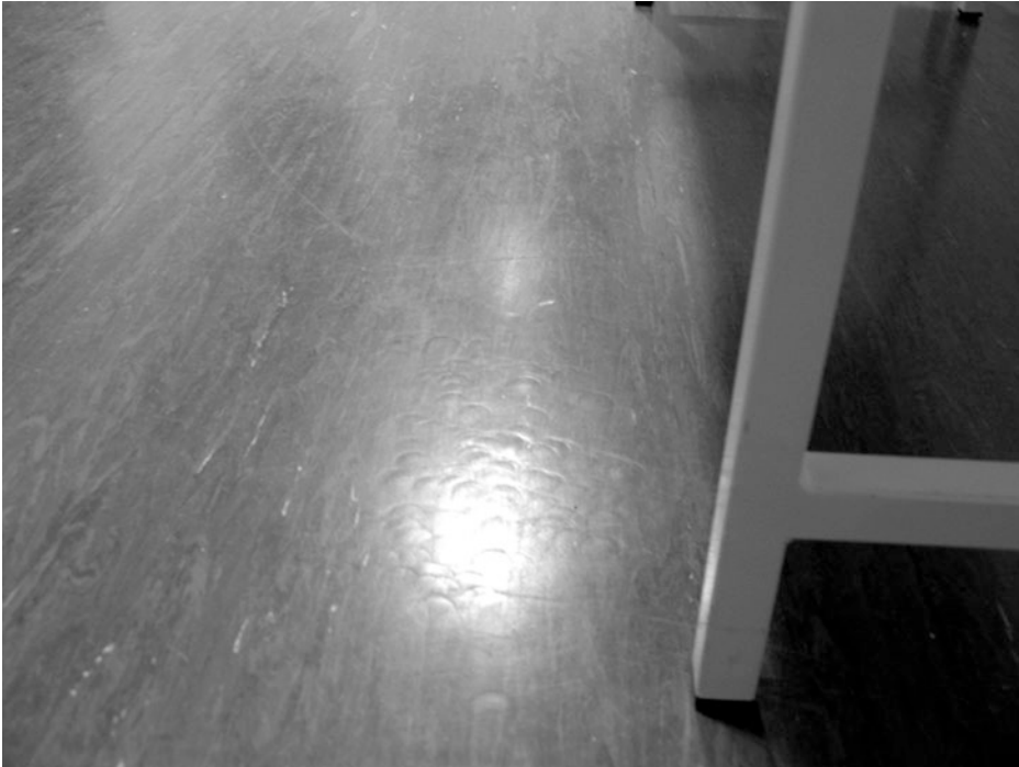
Abb. 12.5 Der Fuß der Untersuchungsliege sieht groß aus. Tatsächlich ist die Aufstandsfläche nur ringförmig schmal und hinterlässt eine Vielzahl ringartiger Resteindrücke
