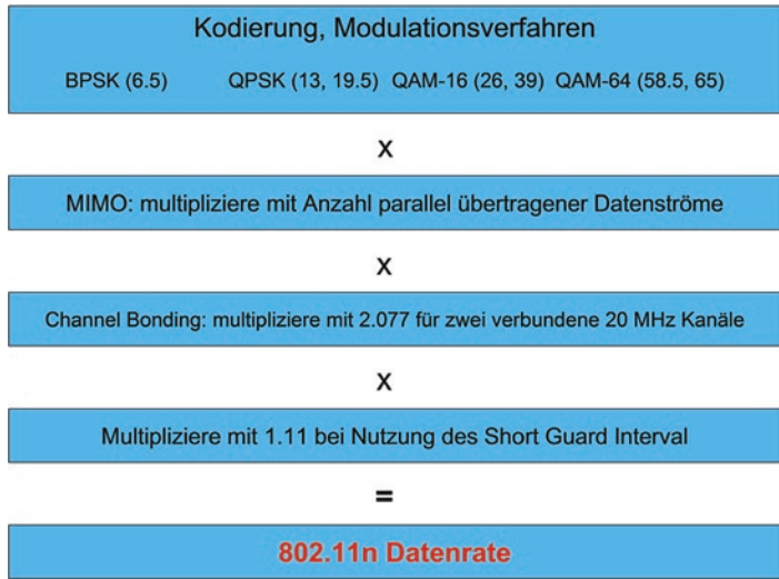
■ Abb. 12.14 Quellen der Erhöhung von Datenraten bei 802.11n
