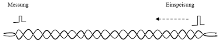
■ Abb. 14.45 Messung der Kabeldämpfung (Insertion Loss)
