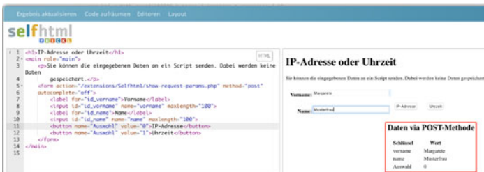
Abb. 4.1 Beispiel <form> : Quellcode ( links ), Aussehen ( rechts ) und übertragene Daten (in der Box rechts unten ) [17]
