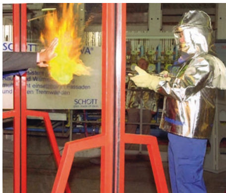
Abb. 2.32 G-Brandschutzglas, Borosilicatglas Pyran®. (Bildrechte: SCHOTT AG)
