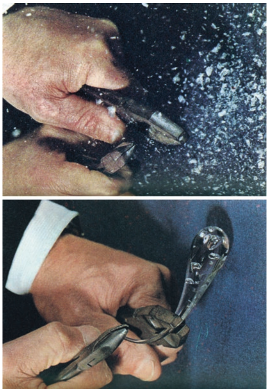
Abb. 2.28 Rupertstropfen – Demonstration des Prinzips des thermischen Vorspannens. (Bildrechte: Deutsches Museum München)
