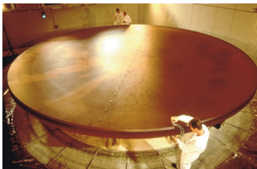
Abb. 2.19 8 m Zerodurspiegel. (Bildrechte: SCHOTT AG)
