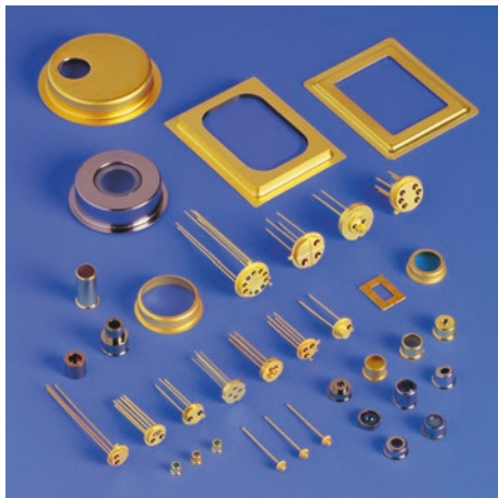
Abb. 2.35 Gehäuse für elektronische Bauelemente mit Glas-Metall-Durchführungen. (Bildrechte: SCHOTT AG)
