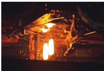
Abb. 3.13 Scherenschnitt von Glaspfropfen. (Bildrechte: Heye-International GmbH)
