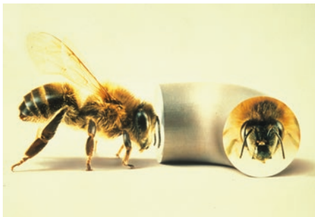
Abb. 2.16 Funktion eines bildgebenden Glasfaserbündels. (Bildrechte: SCHOTT AG)
