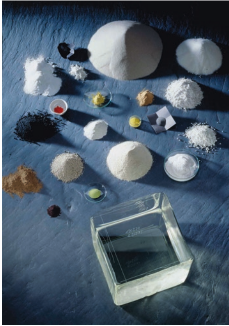
Abb. 2.9 Bestandteile optischer Gläser. (Bildrechte: SCHOTT AG)
