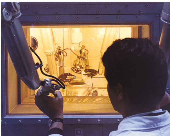
Abb. 2.46 Heiße Zelle mit Strahlenschutzfenster. (Bildrechte: SCHOTT AG)
