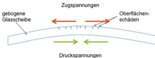
Abb. 4.2 Schema der Entstehung von Zugspannungen an der Oberfläche einer gebogenen Glasplatte
