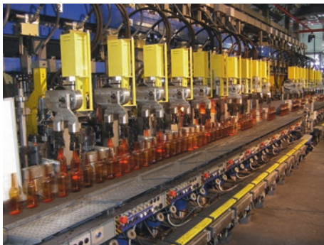
Abb. 3.16 Zwei 10-Stationen IS-Maschinen im Tandembetrieb. (Bildrechte: Heye-International GmbH)
