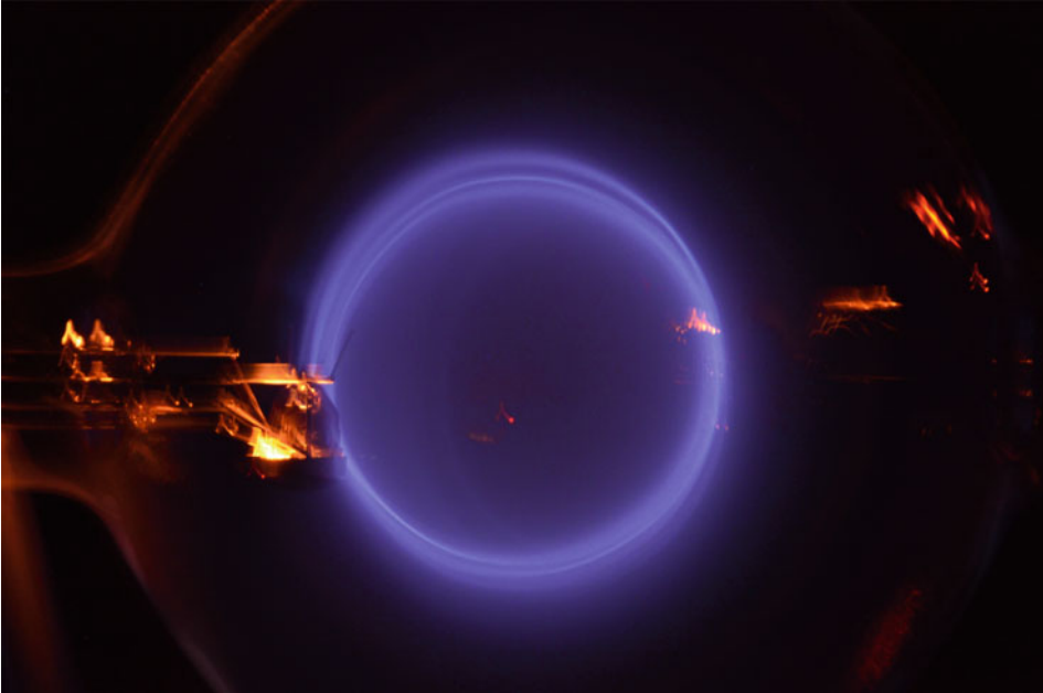
Abb. 5.11 Fadenstrahlrohr im Betrieb. Kameraposition und Brennweite sind identisch mit der aus Abb. 5.10. Die Belichtungszeit beträgt etwa 30 s
