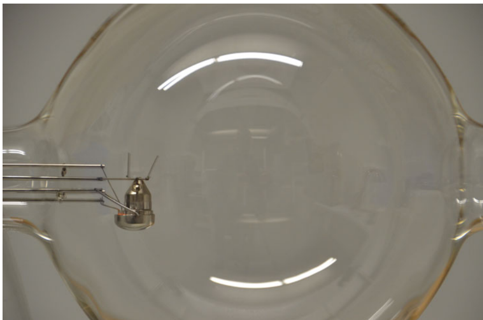
Abb. 5.10 Fadenstrahlrohr bei Beleuchtung. Der Elektronenstrahler befindet sich in der linken Bildhälfte
