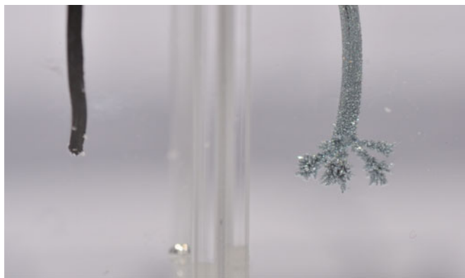
Abb. 9.19 Zinkbaum. Unter den Bedingungen der Elektrolyse findet simultan zur Zinkabscheidung eine Gasbildung an beiden Elektroden statt. Sichtbar ist auch die Trennwand der Photometerküvetten
