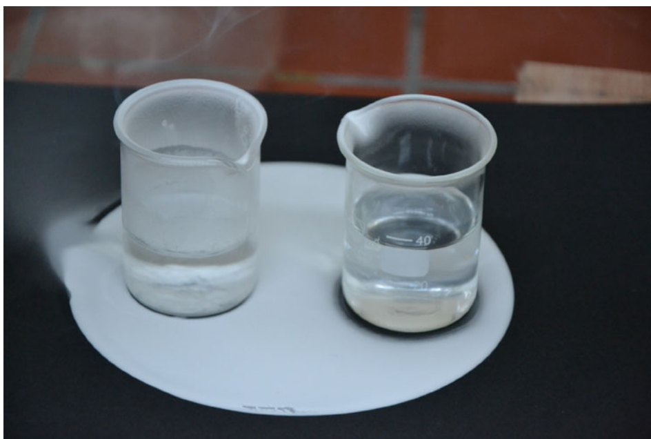
Abb. 1.13 Entstehung von festem Ammoniumchlorid in einer Gasphasenreaktion. Das 2L-Becherglas wurde für das Photo entfernt
