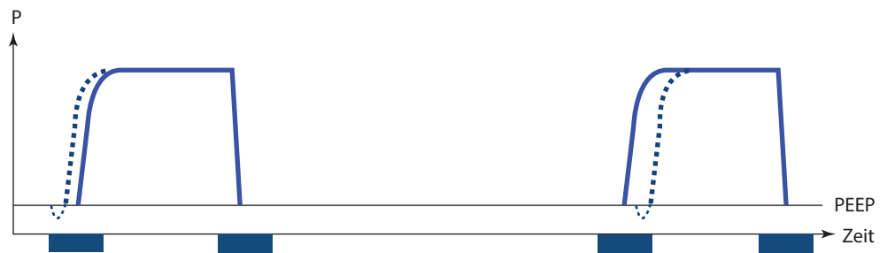
■ Abb. 16.3 Erkennen der Inspiration des Patienten: asynchroner Beatmungshub (durchgezogene Linie) Einatembemühungen (gestrichelte Linie) Triggerfenster (Kästen unterhalb der Zeitachse). (Mit freundlicher Genehmigung von Isabel Schlütter)
