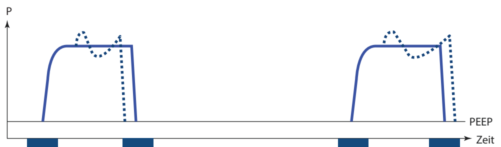
■ Abb. 16.4 Erkennen der Expiration des Patienten: asynchroner Beatmungshub (durchgezogene Linie) Ausatembemühungen (gestrichelte Linie) Triggerfenster (Kästen unterhalb der Zeitachse). (Mit freundlicher Genehmigung von Isabel Schlütter)
