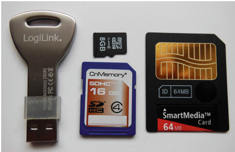
Abb. 1.19 Verschiedene Formen von Speicherkarten. Neben den Karten ist auch ein USB-Speicherstick zu sehen
