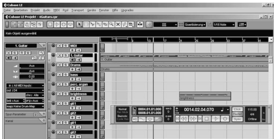
Abb. 4.34 Hauptfenster der MIDI-Software (Cubase LE). Der rechte Bereich zeigt die einzelnen Spuren eines MIDI-Stückes sowie das Transport-Fenster (Vor-/zurückspulen, Wiedergabe/Aufnahme). Links davon befinden sich die einige Schaltfunktionen für jede Spur, wie z. B. Stummschaltung, Soloschaltung, Aufnahmebefreigabe und andere. Ganz links sind weitere Detailinstellungen für die aktuell aktive Spur, z. B. Zuordnung zu welchem Ein- oder Ausgabegerät (diese kann der PC selbst sein, der über sein Audiosystem die MIDI-Daten in Klang übersetzt), welches Programm (also welches Instrument für diese Spur erklingen soll), eingeschleifte Effekte, Lautstärke und anderes mehr
