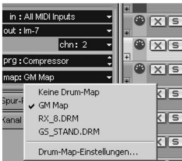
Abb. 4.15 Patchmap. Die Liste zeigt die Zuordnung der Programmnummern. Bei General MIDI ist beispielsweise das Electric Grand Piano auf Platz 2 (bei 0...127). Diese Nummer ist hier innerhalb des Bereiches beliebig veränderbar
