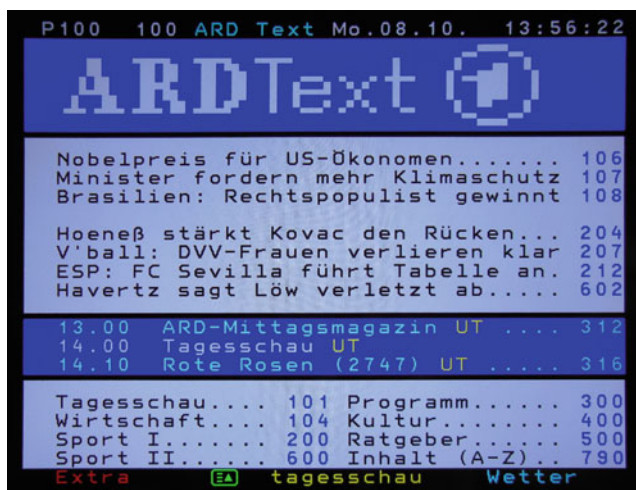
Abb. 11.8 Videotext. Zu sehen ist hier die Startseite (stets Seite 100). Es ist bei den meisten Geräten möglich, den Hintergrund der Textseite transparent zu schalten, damit das laufende Programm erkennbar bleibt
