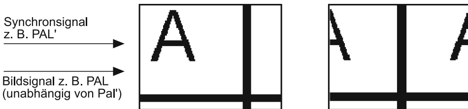
Abb. 7.7 Bildwiedergabe bei unabhängiger Quarzreferenz zwischen Bild-Timing und Synchronisation
