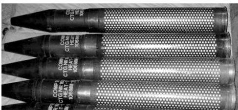
Abb. 3.32. Munition zu einer rückstoßfreien Kanone im Kaliber 106 mm. Die Düse wird durch die gelochte Hülsenwand mit Gas versorgt.
