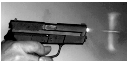
Abb. 4.9. Feuer aus Mündung und Mündungsfeuer bei einer Pistole im Kaliber 9 mm Luger im gleichen Bild. Das Mündungsfeuer ist ringförmig.
