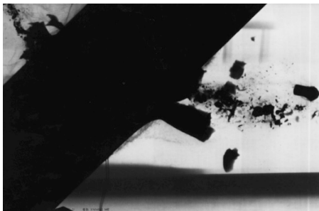
Abb. 6.8. Röntgenblitzaufnahme eines Pfeildurchschusses.
