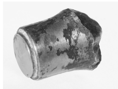
Abb. 6.9. Penetratorstummel nach Grenzdurchschlag durch eine schiefe Platte.
