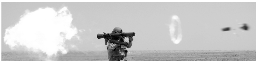
Abb. 4.11. Ringförmiges Mündungsfeuer einer Düsenkanone (84 mm Pzabw-Waffe „Carl Gustav“). Hinter der Waffe ist der Feuerball der rückstoßkompensierenden Düsenströmung zu sehen.
