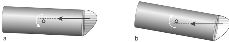
Abb. 5.41. Schulterstabilisierung: Bei kleinen Anstellwinkeln ergibt die entstehende Asymmetrie der Druckverteilung ein stabilisierendes, bei größeren Anstellwinkeln ein destabilisierendes Moment.
