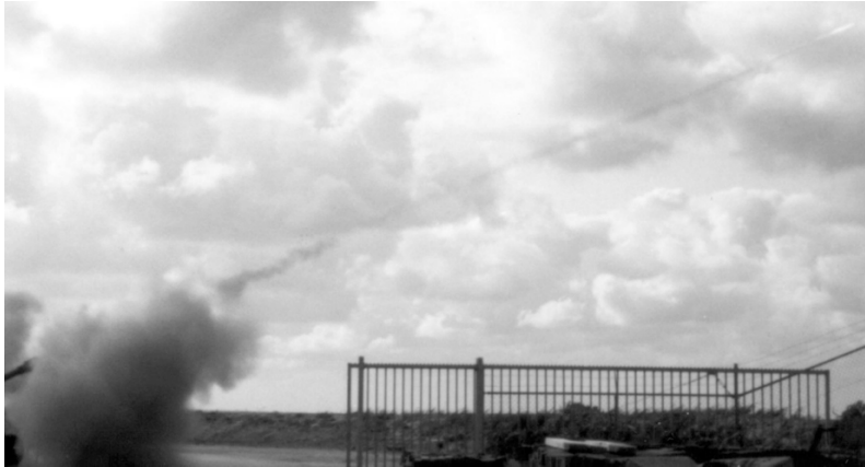
Abb. 5.78. Startphase eines „Base bleed“-Geschosses. Sichtbar das Leuchten des Gasgenerators (rechte obere Ecke), die Rauchspur und die Spur der Anfeuerung.
