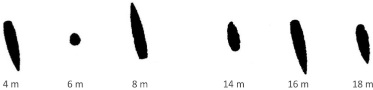
Abb. 5.44. Papierdurchschusslöcher eines ohne Drall geschossenen Geschosses. Der durch die Laufschwingungen und die nachströmenden Pulvergase erzeugte Drehimpuls bleibt während der Flugbahn erhalten. Die Drehung erfolgt um die Achse des größten Trägheitsmomentes. Vergleiche dazu Abb. 7.21 eines stabilen, aber gestörten Geschosses. Die Distanzangaben bedeuten den Abstand von der Mündung.
