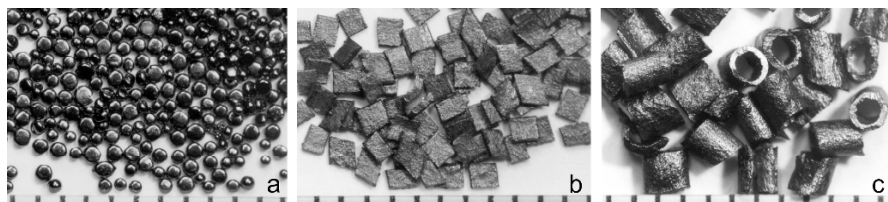
Abb. 3.4. Verschiedene Pulverformen für Kleinwaffen: a: Kugelpulver; b: Blättchenpulver; c: kurzes Röhrchenpulver.
