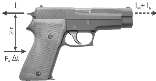
Abb. 4.15. Entstehung des Drehmoments beim Schießen am Beispiel der Pistole. Die Abstützung liegt unterhalb der Wirkungslinie des Rückstoßimpulses. F_a : abstützende Kraft, übrige Bezeichnungen gemäß Abschn. 4.3.2.2.
