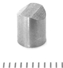
Abb. 5.31. Bild eines „Fragment Simulating Projectile“ (FSP), ein standardisiertes Projektil zur Simulation von Splitterbeschuss. Es existiert in verschiedenen Kalibern und wird vor allem zum Testen von Splitterschutz verwendet (mm-Skala am untern Bildrand).
