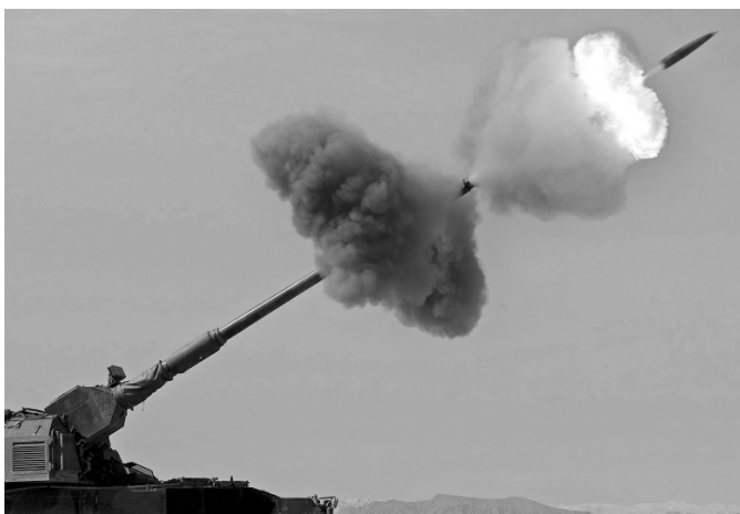
Abb. 4.10. Mündungsfeuer einer 155 mm Panzerhaubitze; sichtbar sind auch die durch die Mündungsbremse nach hinten ausströmenden Gase.
