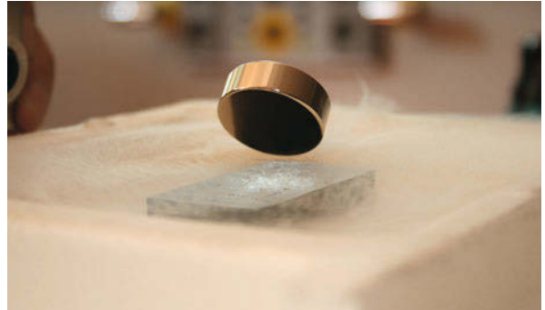
Ein Neodym-Magnet schwebt über einem YBCO Hochtemperatur-Supraleiter.
