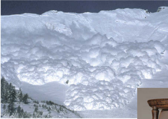
Künstlich ausgelöste Staublawine im Versuchsgelände des WSL-Instituts für Schnee- und Lawinenforschung SLF
