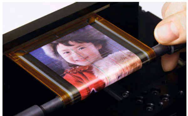
Ein biegsamer Bildschirm, entwickelt von SONY. Er verwendet OLEDs, die dünner als ein menschliches Haar sind.
