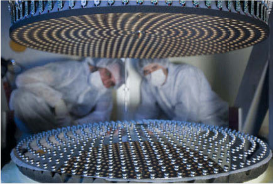
Die Rückseite eines Spiegels mit 672 Steuerelementen
