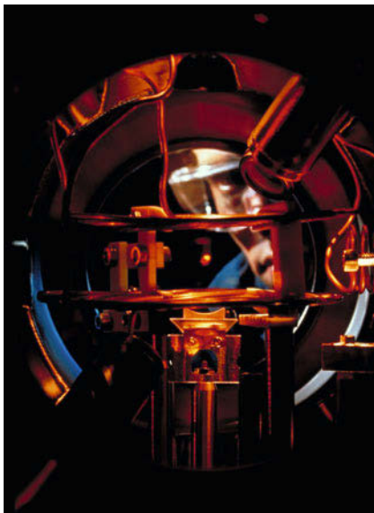
Atome in der Falle: Der leuchtende Punkt im Zentrum ist ein lasergeköhltes Stück Materie, durch Magnetfelder an Ort und Stelle gehalten (H.M. Helfer/NIST).
