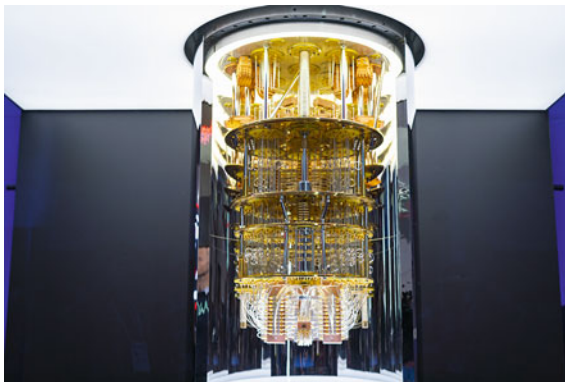
Abb. 4.7 Das „IBM Q System One“ ist einer der modernsten Quantencomputer. Die Firma IBM stellt einiger ihrer Modelle der Industrie und Forschung zur Verfügung. Aber auch ein Jeder oder eine Jede kann online auf diese Maschinen zugreifen, erste Rechenexperimente durchführen und so das Programmieren auf Quantencomputern erlernen. (Quelle: IBM)
