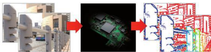
Bei der DFD-Autofokustechnologie werden zunächst zwei „Probeschüsse“ mit verschiedenen Fokuseinstellungen des Objektivs gemacht und dann mit der Kontrastmessung verrechnet.
