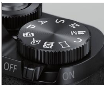
Die Belichtungsbetriebsarten P/A/S/M, der „iA“-Modus, die Szene- und Kreativprogramme finden sich alle auf dem Modusrad der GX80.
