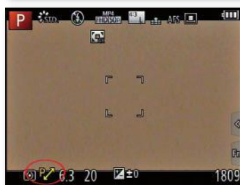
Oben die von der Programmatik gewählte Zeit-/Blenden-Kombination. Unten der Shift-Wert, den Sie mit dem Einstellrad verändern können.
