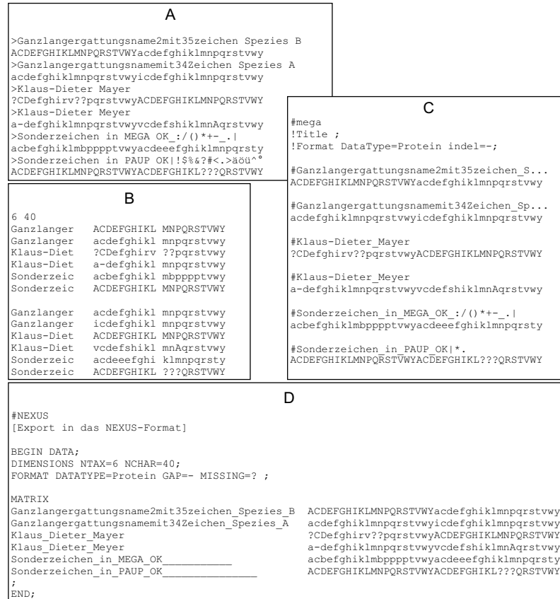
Abbildung 3.12 Verschiedenen Dateiformate, hier zur Beschreibung eines kurzen Proteinsequenzalignments mit Aminosäureabkürzungen im Ein-Buchstaben-Code. A: Das FASTA-Format ist durch das Zeichen '>' gekennzeichnet, dem der jeweilige Sequenzname folgt. Die Sequenz selbst folgt dann in der nächsten Zeile (oder den nächsten Zeilen) bis ein neuer Sequenzname mit dem nächsten '>' beginnt. Das FASTA-Format wird von den meisten Programmen eingelesen, aber die Sequenznamen werden dann unterschiedlich abgekürzt. B: Das PHYLIP-Format legt die meisten Beschränkungen auf. In der ersten Zeile sind die Anzahl der Sequenzen und die Länge des Alignments genannt, es folgen die Sequenznamen mit maximal zehn Zeichen. Hier der Export aus BioEdit; die Sequenzen können im Prinzip auch direkt auf die Sequenznamen folgen. Bei PAML hingegen, das auch mit dem PHYLIP-Format arbeitet, sind zwei Leerzeichen erforderlich, dafür können die Sequenznamen bis zu 30 Zeichen lang sein. C: Im programmspezifischen MEGA-Format werden Sequenznamen bis zu 40 Zeichen und mit einigen Sonderzeichen erlaubt (hier der Import der FASTA-Datei unter A). Andere Sonderzeichen werden teils ignoriert oder führen andernteils zu Problemen in der MEGA-Alignmtoberfläche. D: Das flexible NEXUS-Format wird von vielen Programmen verwendet und gelesen. Es ist in so genannten Blöcken organisiert, die jeweils mit begin... starten und mit end; aufhören. In einer NEXUS-Datei können an beliebiger Stelle durch eckige Klammern gekennzeichnete Kommentare eingefügt werden. Das eigentliche Alignment liegt hier im Beispiel (als 'Matrix') in einem data -Block vor. Hier dargestellt ist der Export ins NEXUS-Format aus PhyDE, bei dem alle Sonderzeichen automatisch in den Unterstrich umgesetzt worden sind. Normalerweise werden Sequenzen kontinuierlich in einer Zeile aufgeführt, für das PHYLIP-Format dargestellt ist hingegen die Interleave -Variante, bei der das Alignment in untereinanderstehende Sequenzblöcke aufgeteilt ist.
