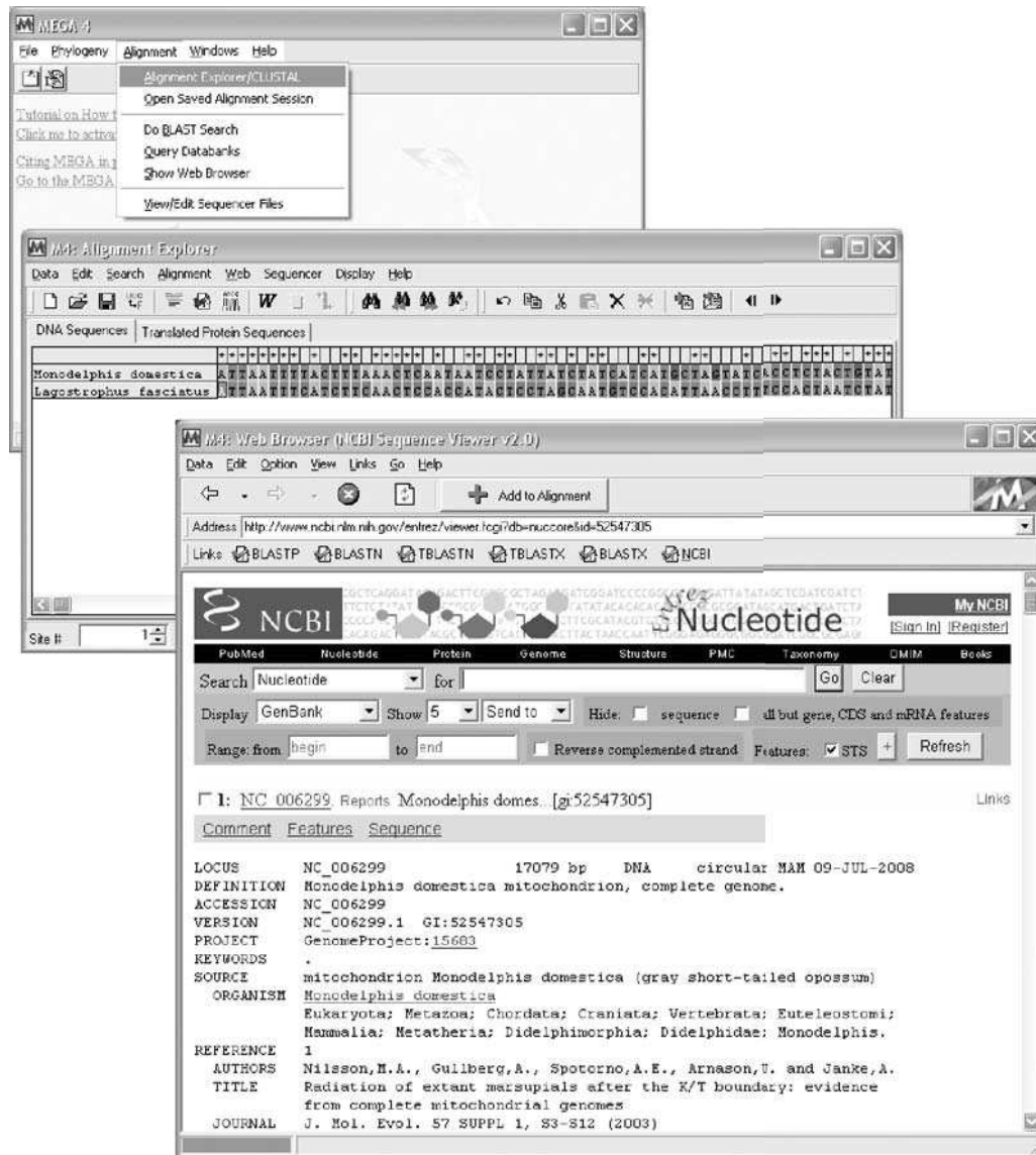
Abbildung 4.1 Schritte der Alignmenterstellung in MEGA . Oben links: Programmstart, Aufruf des Alignment Explorers (Mitte) im Alignment -Menü. Der Alignment Explorer ermöglicht das Einlesen von einzelnen Sequenzen und Alignments in verschiedenen Formaten, außerdem die Identifizierung von Datenbankeinträgen am NCBI über eine BLAST-Homologiesuche (5. Schaltfläche v. links) oder eine textbasierte Datenbanksuche (6. Symbol v. links). Unten: Abrufen einer Sequenz aus dem WWW Explorer in die Alignment-Oberfläche. Hier dargestellt ist die komplette mitochondriale Sequenz von Monodelphis domestica . Ein Mausklick auf die CDS ( coding sequence ) des nad5 -Gens (weiter unten im Eintrag) schneidet den codierenden Bereich von 1827 Bp heraus. Mit einem Klick auf „Add to alignment“ wird schließlich die aktuell im Fenster befindliche Sequenz als neuer Eintrag in die Oberfläche des Alignment Explorers hinzugefügt. Hier im Beispiel ist auch bereits die nad5 -Sequenz von Lagostrophus fasciatus geladen.
