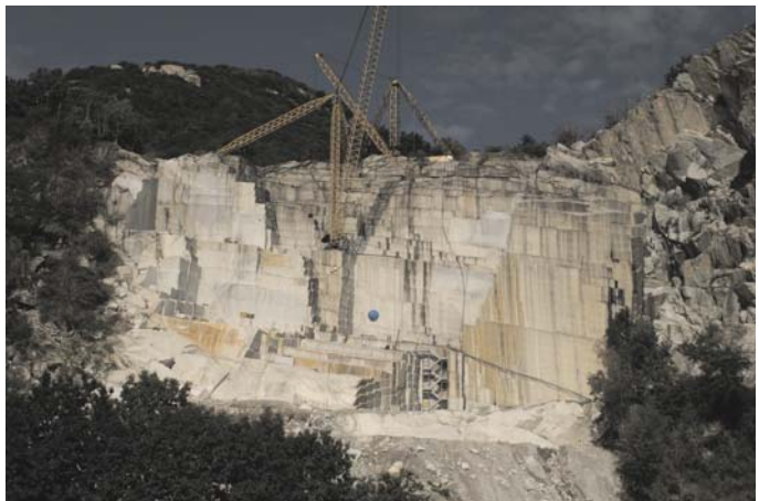
Abb. 8.17 Abbau von Werksteinen lohnt sich nur dort, wo ein weitständiges Trennflächengefüge vorliegt. GRANITO BIANCO MONTORFANO, Granit, hellgrau, Mergozzo/Italien.
