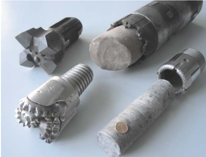
Abb. 8.11 Bohrwerkzeuge zum Bohren im Fels, rechts mit und links ohne Kerngewinn. Links oben: Kreuzmeißel. Links unten: Rollenmeißel. Rechts zwei Beispiele für Bohrkronen, die bei Rotation den Bohrkern (mit im Bild) aus dem Gestein fräsen.
