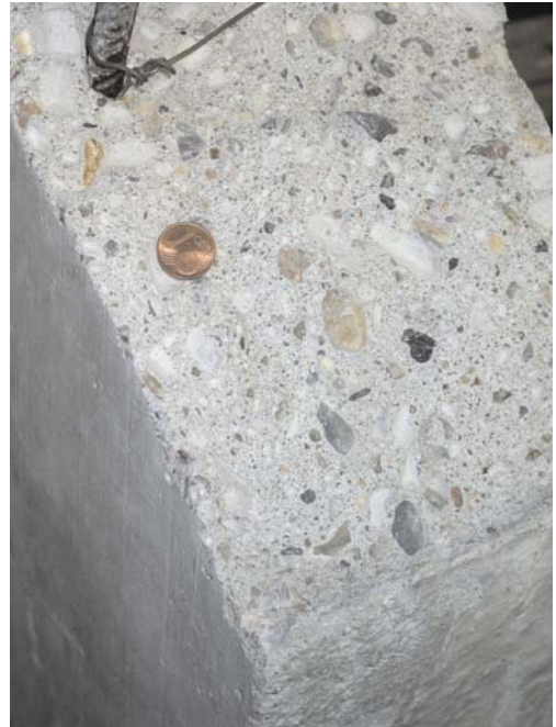
Abb. 7.31 In einem Stück ausgebrochenem Beton sind gut die Kies-Zuschlagstoffe zu erkennen.
