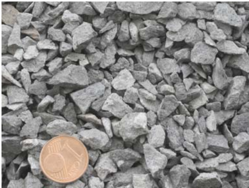
Abb. 8.13 Brecherprodukte. Splitt aus einem Phonolith (links) und Schotter aus einem Granit (rechts).
