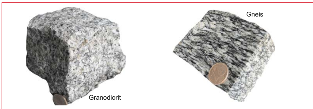
Abb. 5.3 Ein simpler Pflasterstein offenbart die Regellosigkeit magmatischer Gefüge. Die Anordnung der Minerale ist von allen Seiten gleich (Granodiorit, Demitz-Thumitz/Lausitz). Zum Vergleich ein metamorphes Gestein mit einer deutlichen Anisotropie. Dieser Gneis ist aus dem Granodiorit hervorgegangen (Freiberg/Erzgebirge).
