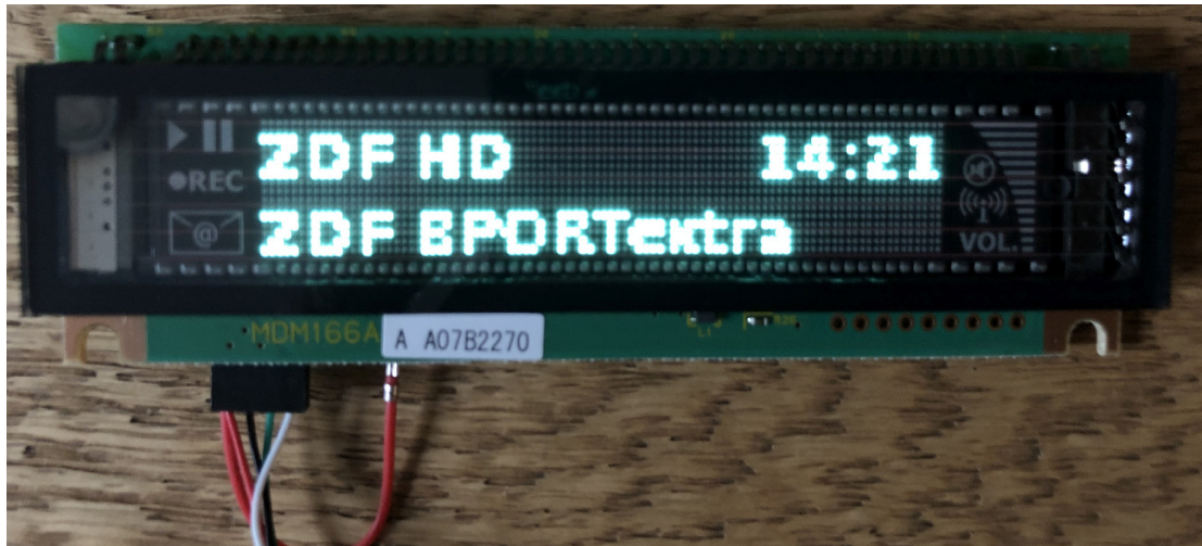
Abbildung 7.21: Das Eisgold VFD leuchtet sehr hell und kann auch aus größerer Entfernung gut abgelsen werden [77].
