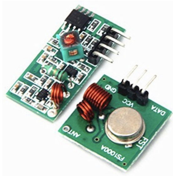
Abbildung 9.14: 433 MHz Sender (rechts) und Empfänger (links) (Quelle: https://www.amazon.de [102]).
