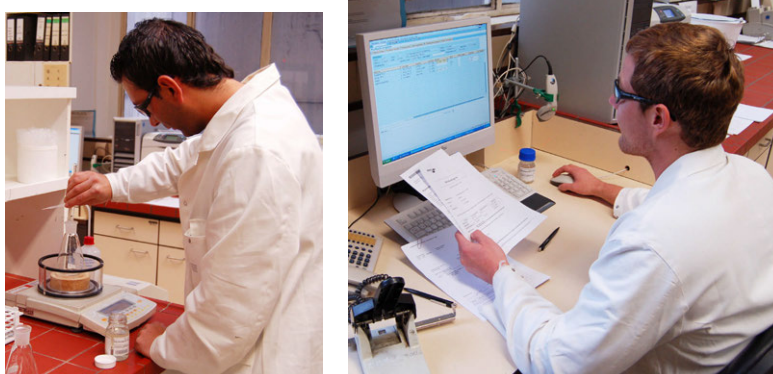
Abb. 1.1: Qualitätskontrolle bei der Tensideherstellung (Säurezahlbestimmung und Eingabe für die statistische Auswertung); Quelle: Evonik Industries AG, Essen
