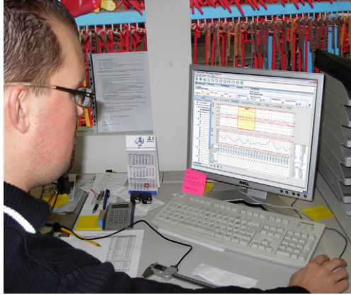
Abb. 15.3: Anwendung einer Qualitätsregelkarte (Serienproduktion von Platinen; Quelle: Fa. Böhme und Weihs Systemtechnik)
