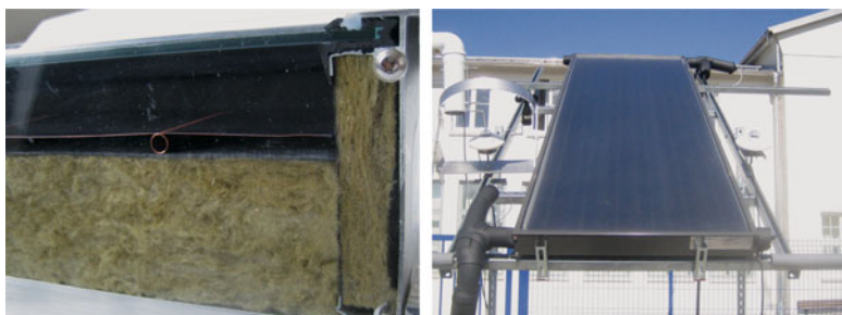
Abb. 3.3 Kollektorschnittmodell ( links ) und Flachkollektor auf einem Leistungsprüfstand ( rechts )
