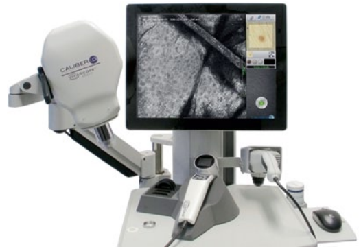
■ Abb. 6.2 Nahaufnahme des großen Tubus des VivaScope 1500, des 3000er Handgerätes, der VivaCam und von Zubehörteilen wie dem Gewebering, Klebefenster, Ultraschallgel
