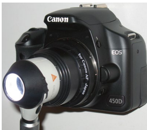
■ Abb. 5.3 Modulares DView-System aus Kamera, Adapter und Dermatoskop. (Mit freundlicher Genehmigung von Canon)
