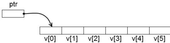
Abb. 4.3: Array mit einem Zeiger auf das erste Element
