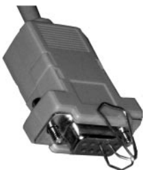
Abb. 5.43: Schaltung zur Erzeugung eines Echos an der seriellen Schnittstelle; eine Büroklammer verbindet die Buchse 2 und 3.
