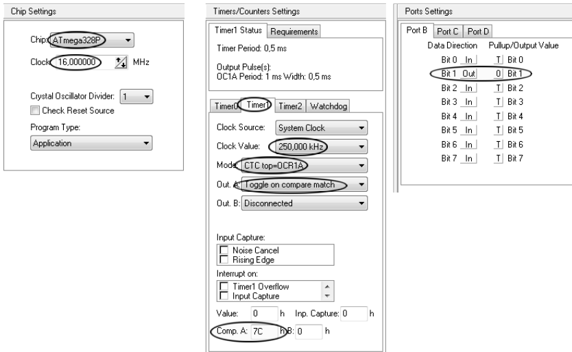
Abb. 7.4: Konfiguration von Timer 1 im CTC-Modus im CodeVisionAVR
