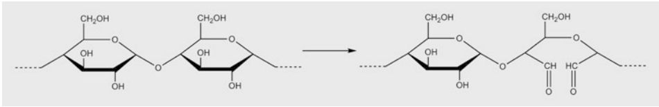
■ Abb. 7.37 Bildung von Dialdehydstärke durch Oxidation mit Natriumperodat
