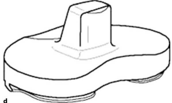
■ Abb. 7.65a–d Intrinsische Stabilität der Prothese durch Verwendung verschiedener Inlays. a Standard-CR-Inlay mit relativ gering ausgeprägter Konkavität. b Hochkongruentes Inlay mit stärker ausgeprägter Konkavität und erhöhter a. p.-Stabilität. c PS-Inlay mit erhöhter a. p.-Stabilität. d CC-Inlay mit erhöhter a. p.- und Varus-/Valgus-Stabilität durch Zapfenmechanismus (Mit freundlicher Genehmigung der Fa. Smith & Nephew)
