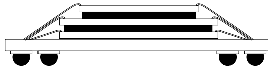
Bild 6.2 Stapeln von gehäuten Chips — System In Package (SIP).
