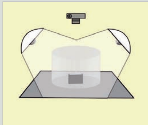
Aufbau und Beleuchtung mit einem improvisierten Lichtzelt
