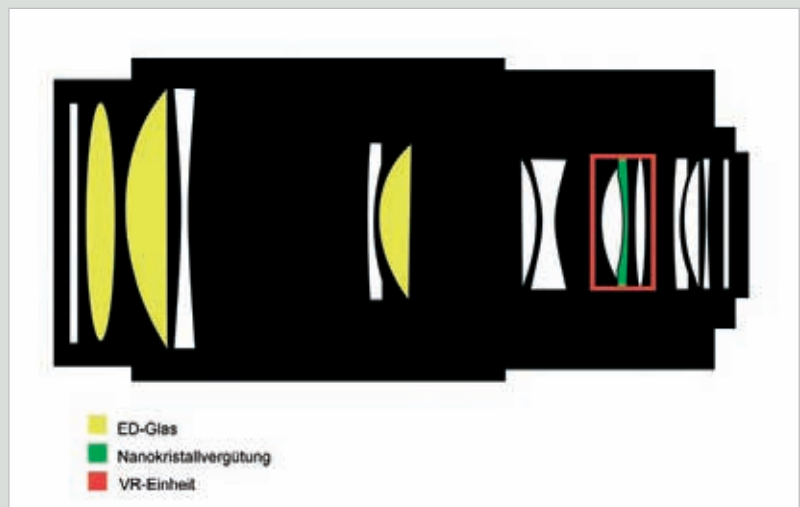
Ein Teleobjektiv mit VR-Einheit, schematisch dargestellt.
