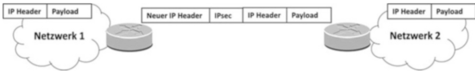
Abb. 2.5 VPN: Tunnel-Modus bei IPsec
