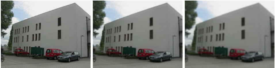
Abb. 6.4 Gaußfilter 2. Original RGB-Bild ( links ) und mit \sigma = 1,7 ( Mitte ) und \sigma = 3 ( rechts ) pro RGB-Kanal gaußgefiltert
