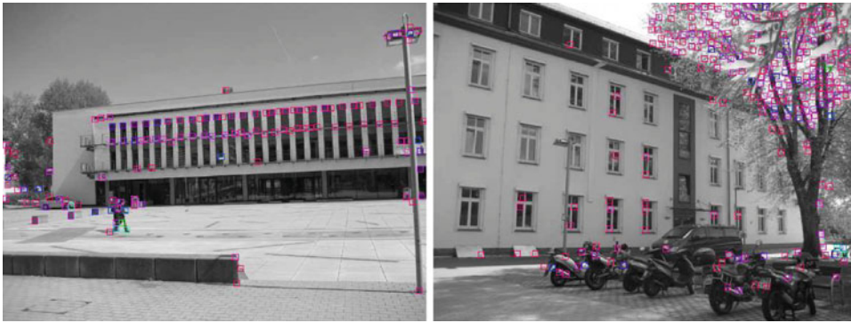
Abb. 9.21 Harris-Stephens-Eckendetektor 1 mit quadratischem Fenster vom Radius 4
