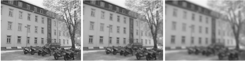
Abb. 6.3 Gaußfilter 1. Original ( links ) und mit \sigma = 2 ( Mitte ) und \sigma = 5 ( rechts ) gaußgefiltert
