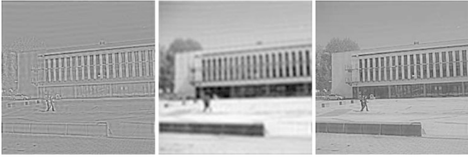
Abb. 8.7 Beispiele einer Hochpass- (links), Tiefpass- (Mitte) und Bandpassfilterung (rechts)
