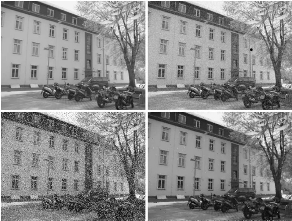
Abb. 4.8 Diverses Rauschen. Original Beispielgebäude 2 (oben links), mit Gauß'schem Rauschen mit \sigma = 20 (oben rechts), mit sehr starkem Salz-und-Pfeffer Rauschen (10 % aller Pixel auf Weiß und anschließend 10 % auf Schwarz gesetzt, unten links) und mit einem Medianfilter einmal korrigiert (unten rechts)
