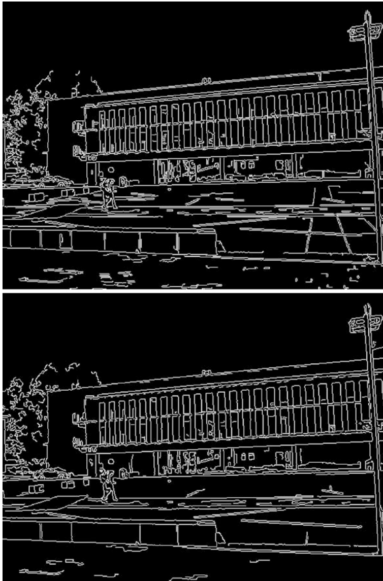
Abb. 9.6 Canny-Kantendetektion. Resultat von Beispielgebäude 1, oben mit vorheriger Gaußfilterung, unten mit vorheriger Kuwahara-Filterung
