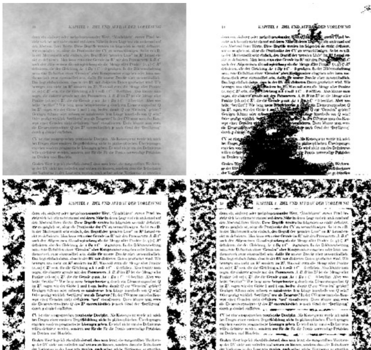
Abb. 5.6 Dynamische Binarisierungen. Original ( oben links ), mit Otsu statisch binarisiert ( oben rechts ) und dynamisch binarisiert mit Umgebungen des Radius 20 ( unten links ) und 10 ( unten rechts ) um jedes Pixel.
