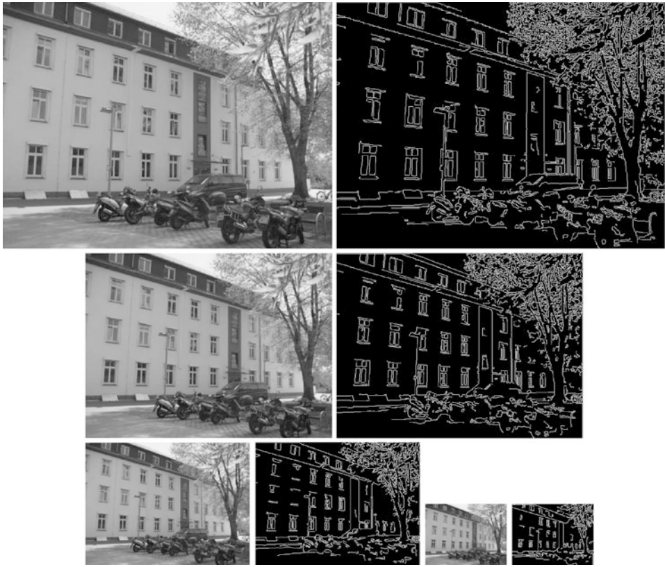
Abb. 12.5 Skalenräume 1. Skalierung auf 100 %, 75 %, 50 % und 25 % der Höhe und Breite mit Canny-Operator auf die kleiner werdenden Bilder
