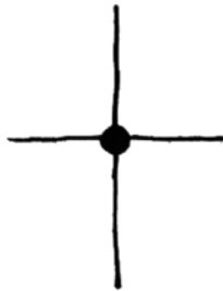
Abbildung D-3: Das Schaltkreissymbol für verbundene Drähte
