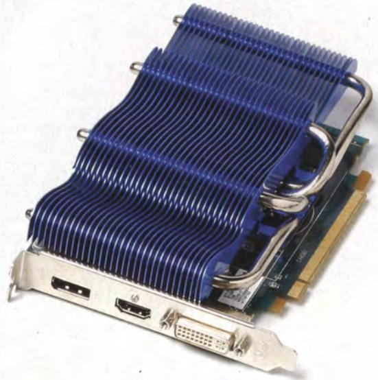
Grafikkarten mit 28-Nanometer-Chips sind sehr sparsam. Dadurch lassen sich selbst spielfähige 100-Euro-Modelle noch lüfter- und damit lautlos kühlen.
