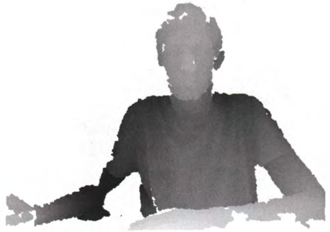
Im Tiefenbild der Kinect kodieren die Grauwerte die Entfernung: Hell bedeutet nah, dunkel weiter weg. Die ausgefranzten Kanten und Löcher entstehen durch das Messverfahren der Kamera.
