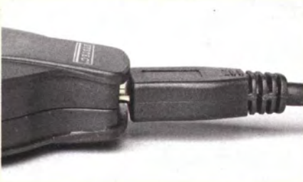
Auch bei einem Hub von Xystek verursacht eine unnütze Plastiknase am Gehäuse einen Wackelkontakt, weil der Micro-B-Stecker nicht fest sitzt.
