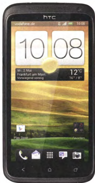
Das HTC One XL unterstützt die LTE-Bänder um 800, 1800 und 2600 MHz und funkt damit in allen deutschen LTE-Netzen.
