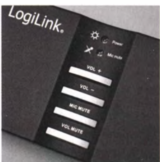
Die Mic-Mute-Taste bei der LogiLink Sound Box wirkt direkt auf die Mikrofoneingänge der Karte und ist besonders beim Telefonieren praktisch.
