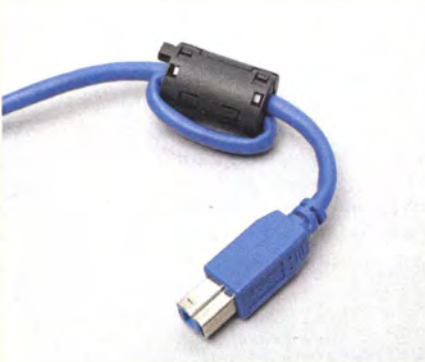
Verzweiflungstat: Braucht der Hersteller bereits bei einem kurzen Kabel eine Ferrit-Drossel, so spricht das nicht gerade für Störsicherheit und Zuverlässigkeit.
