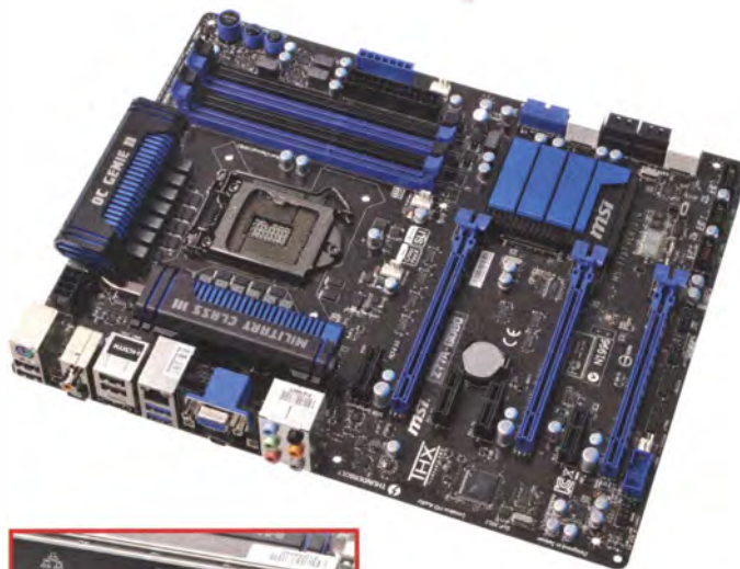
Mit dem Z77A-GD80 liefert MSI eines der ersten Desktop-PC-Mainboards mit Intels Thunderbolt-Chip „Cactus Ridge“.
