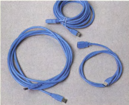
Passive Verlängerungskabel sieht die USB-Spezifikation nicht vor. Während wir in unserem Test sowohl mit 1- als auch 3-m-Kabeln erstaunlich gute Ergebnisse erzielten, zickte ein 2-m-Kabel.
