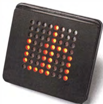
Eine Matrix aus 8 x 8 Farb-LEDs leuchtet frei programmierbar auf Funkbefehl auf – und signalisiert die korrekte Funktion des Makro-Moduls.
