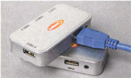
Verschlimmbessert: Beim oberen Hub hält der Micro-B-Stecker nicht, der Nachfolger nutzt unerlaubterweise eine A-Buchse für den Anschluss an den PC.
