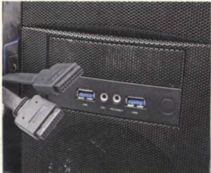
Konstruktionsfehler: Jede der beiden USB-3.0-Frontbuchsen braucht einen eigenen 19-poligen Pfosten-Stecker, nutzt von den beiden darüber verfügbaren Ports dann aber nur je einen.
