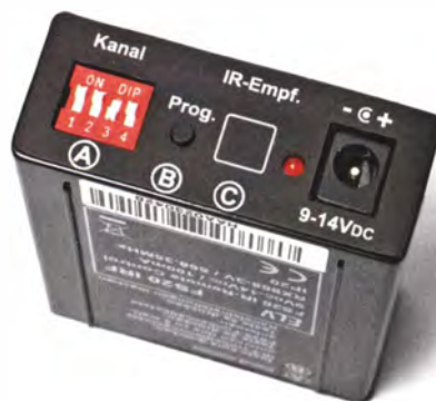
Koppelt Funk- und DMX-Welt per Infrarot: Das FS20-IRF lässt sich mit FS20-Adressen und Infrarot-Befehlen programmieren.
