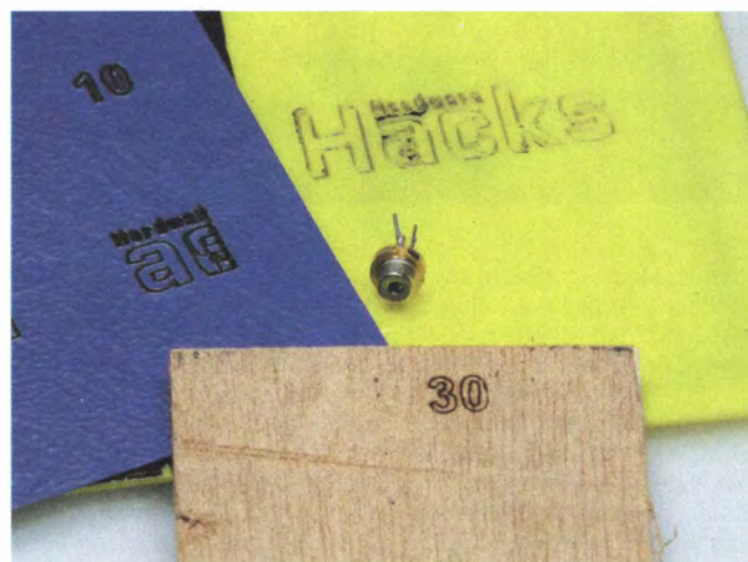
Klein, aber oho! Die Laserdiode brennt in Holz und schneidet in Kunststoff.
