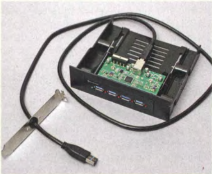
Von vorne nach hinten durch die Brust: Das Anschlusskabel des internen 4-Port-Hubs von Sharkoon soll man hinten wieder aus dem PC-Gehäuse herausführen.
