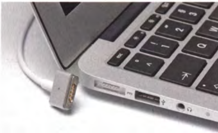
Das MacBook Air hat nun auch den schmalen Mag-Safe-2-Stromanschluss und USB 3.0.
