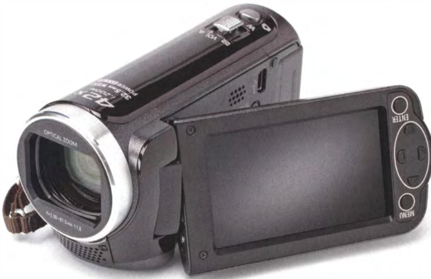
Ohne Touchscreen, dafür mit Tastern an der Display-Klappe: Beim Panasonic HC-V100 kann man viele Parameter manuell steuern.
