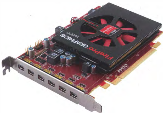
Die für Display-Wände gedachte FirePro W600 steuert bis zu sechs Bildschirme gleichzeitig an.
