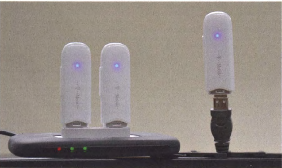
Die virtuellen Honeypots verwendeten jeweils einen der an den Server angesteckten UMTS-Sticks als Internet-Zugang.
