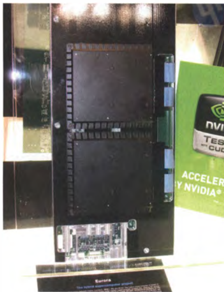
Hinter diesen Kühlkörpern sollen sie sitzen, die heiß erwarteten Kepler-GK110-Chips, hier am Stand von EuroTech.
