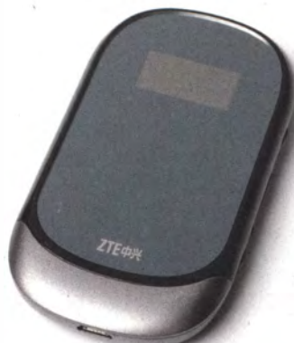
Flunderflaches Gehäuse, microSD-Slot von außen zugänglich, aber Orientierung der Karte unklar: ZTE MF62
