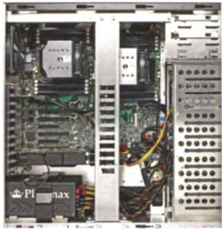
CADNetwork nutzt für die W60 ein Standard-Gehäuse mit SATA-Backplane und verbindet drei der sechs Ports mit dem SAS-Controller des Intel-Chipsatzes.
