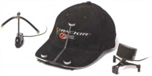
Der TrackIR erfasst Kopfbewegungen zwar sehr genau – aber nur, wenn man sich im Blickfeld der Kamera befindet. Und: Man muss ein zusätzliches TrackClip-Gestell tragen.
