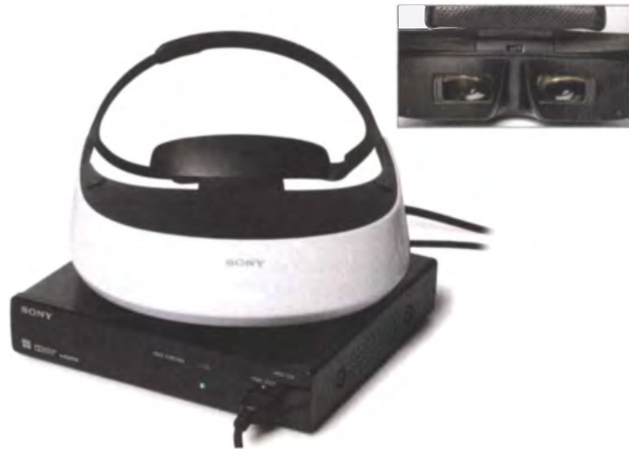
Sonys Privatkino ist ein echter Klopper – stolze 325 Gramm bringt die HMZ-T2 auf die Waage. Die Bildqualität ist beeindruckend, der Tragekomfort weniger.
