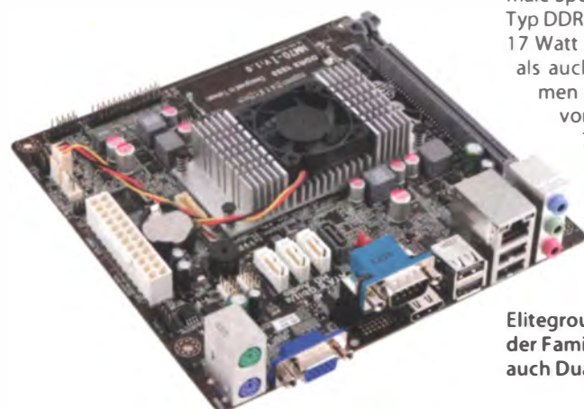
Der Celeron 847 auf dem NM70I-847 von Biostar soll die Lücke zwischen Atom und Core i schließen.
