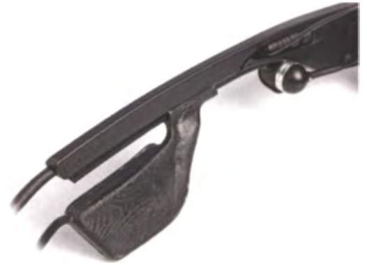
Der Prototyp des Zeiss-Headtrackers sieht noch selbst geschnitzt aus, funktioniert aber tadellos. Man steckt ihn auf den Bügel der Zeiss-Brille, er lässt sich aber auch mit anderen Geräten nutzen.
