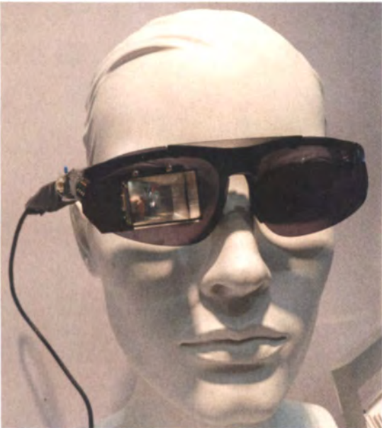
In den Pixeln des bidirektionalen OLED sitzen kleine Sensoren. Mit ihnen kann das Display des Fraunhofer IPMS die Augenbewegung erfassen und gleichzeitig das AR-Bild ausgeben.
