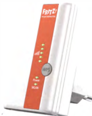
Der Fritz!Repeater 310 von AVM vergrößert die Reichweite von Funknetzen im 2,4-GHz-Band.
