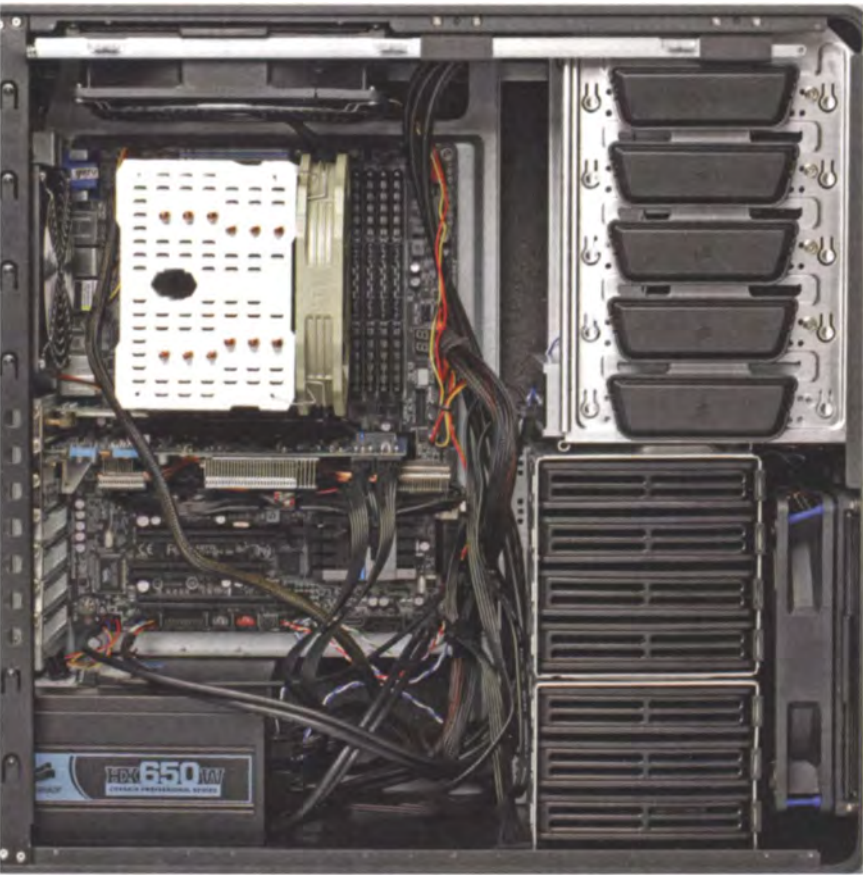
Der gewählte CPU-Kühler (oben links) ist riesig und könnte leiser sein, wie sich im Audio-Messlabor zeigte.
