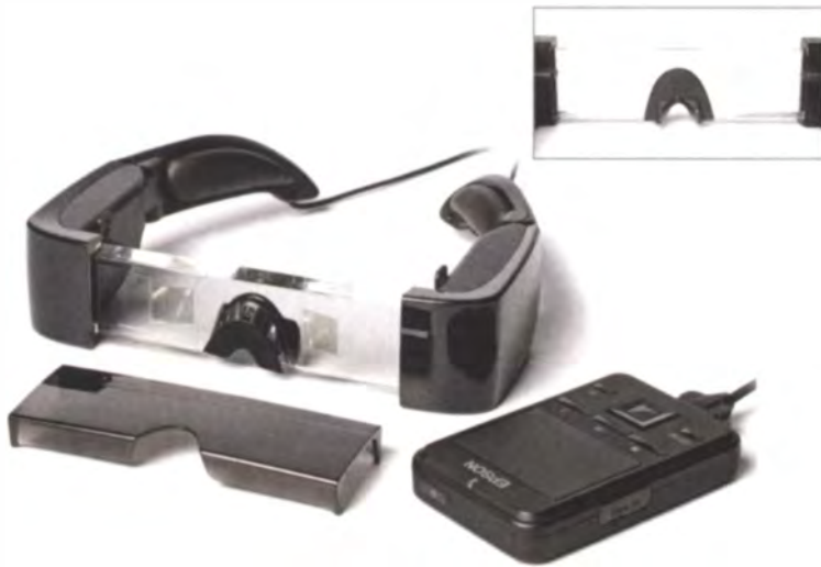
Epsons Moverio-Brille hat keinerlei Videoanschlüsse, die Bilder kommen ausschließlich vom Android-2.2-System in der Steuerbox auf den Schirm.
