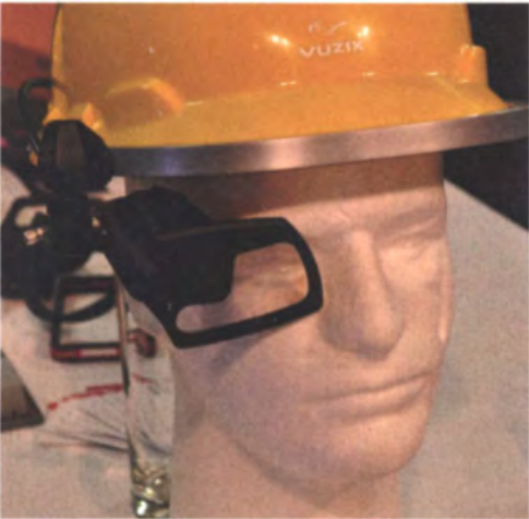
Bei Vuzix einäugigem HMD verlässt das Licht des seitlich angebrachten LCD das Brillenglas erst an der eingepprägten Hologrammstruktur.
