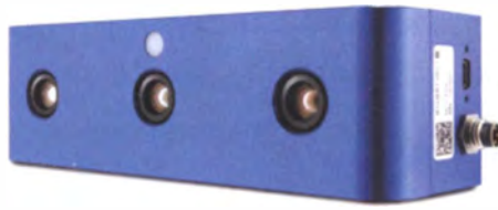
Eine stereoskopische Kamera und ein Beamer erfassen in der Ensensio N10 Objekte dreidimensional.
