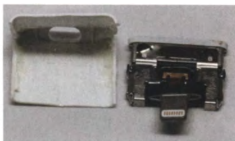
Apples Lightning-Adapter besitzt unter anderem einen Digital-Analog-Konverter.
