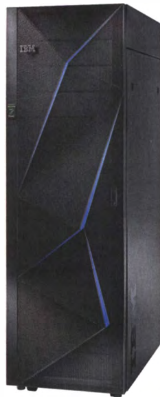
IBM Power 780: Mit Power7+ sind maximal 128 CPU-Kerne und 4 TByte RAM möglich.
