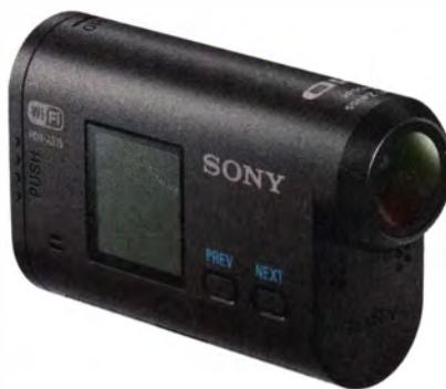
**Der kompakte Action-Camcorder Sony HDR-AS15 hat selbst kein Display zur Bildkontrolle, überträgt Vorschaubilder aber per WLAN an Smartphones.**
