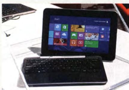
Dell verriet nur wenige Details seines RT-Tablets XPS 10. Mit Hilfe des Zusatzakkus in der Tastatur hält es angeblich 20 Stunden ohne Steckdose durch. Das Display hat dieselbe Größe wie bei Asus und Samsung: 10 Zoll.
