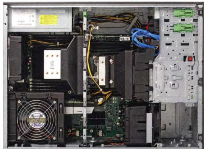
Fujitsu verfolgt beim Systemaufbau der R820 noch einen klassischen Ansatz mit lose verlegten Kabeln und einzelnen Lüftern. Einzig die Laufwerke sind über die Front leicht zugänglich.
