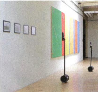
Ferne den Besuch einer Messe, eines Museums oder ein Treffen im Büro zu ermöglichen. Das iPad (2 oder 3 mit Kamera) wird auf einen Teleskopständer montiert. Der Ständer kann per Motor auf maximal 1,5 Meter ausgefahren werden, sodass die Kamera des iPad sich der Augenhöhe anderer Personen anpassen kann. Eine App auf einem anderen iOS-fähigen Gerät steuert den Tele-präsenzroboter, der etwa per WLAN in einem Netz eingebucht
