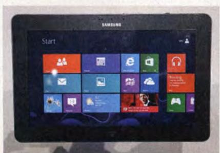
Samsungs Ativ Tab wiegt 570 Gramm und ist knapp 9 Millimeter dünn, sein Akku soll 12 Stunden durchhalten. Auf der Unterseite finden sich Öffnungen für eine Ansteck-Tastatur – Samsung präsentierte das Tablet aber solo.
