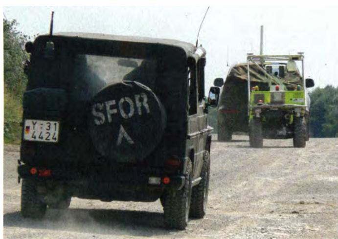
Bei der Elrob wird unter anderem das autonome Fahren im Konvoi geprobt.
