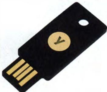
Der Yubikey Neo funktioniert Einmalpasswörter über den Nahfunkstandard NFC an Android-Smartphones.
