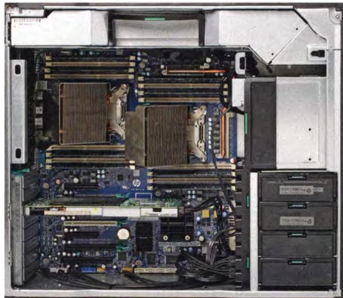
Erst wenn man die Lüftungskanäle entfernt, wird der Blick auf das Inneneleben der HP Z820 frei. Vom Laufwerk bis zum Netzteil lässt sich alles leicht austauschen.
