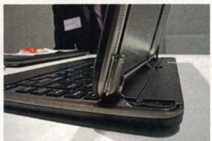
Toshiba bringt ebenfalls ein Core-i-Gerät mit Schiebemechanismus. Es ist noch größer (12,5 Zoll) und schwerer (1,4 Kilogramm) als das Sony-Modell. Die Neigung des Displays lässt sich wie bei einem richtigen Notebook verstellen.
