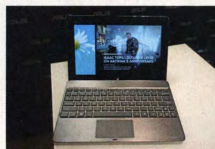
Asus brachte hingegen seine Tastatur mit: Mit ihrem Zusatzaku verlängert sie die Laufzeit des Vivo Tab RT. Das Tablet wird von Nvidias-Quad-Core Tegra 3 angetrieben und wiegt laut Asus lediglich 520 Gramm.
