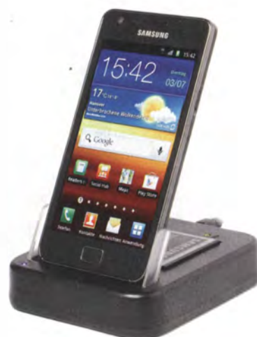
In speziellen Ladeschalen lädt nicht nur das Smartphone, sondern auch ein Zusatzakku. Stärkere Akkus passen allerdings nicht immer hinein.
