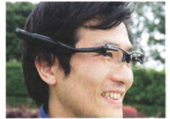
Im 20 cm langen Bügel der AR-Brille MEG 4.0 von Olympus stecken Elektronik und Optik, Daten empfängt der Clip per Bluetooth.
