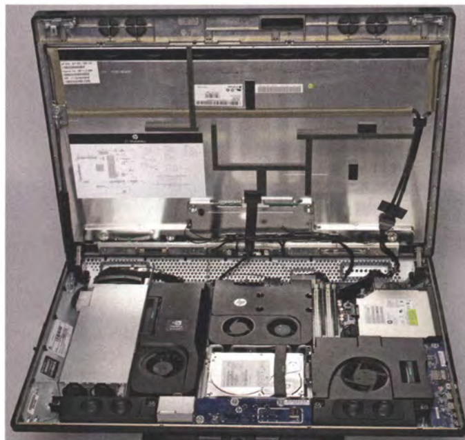
An alle wichtigen Komponenten der Z1 kommt man ohne Werkzeug heran.
