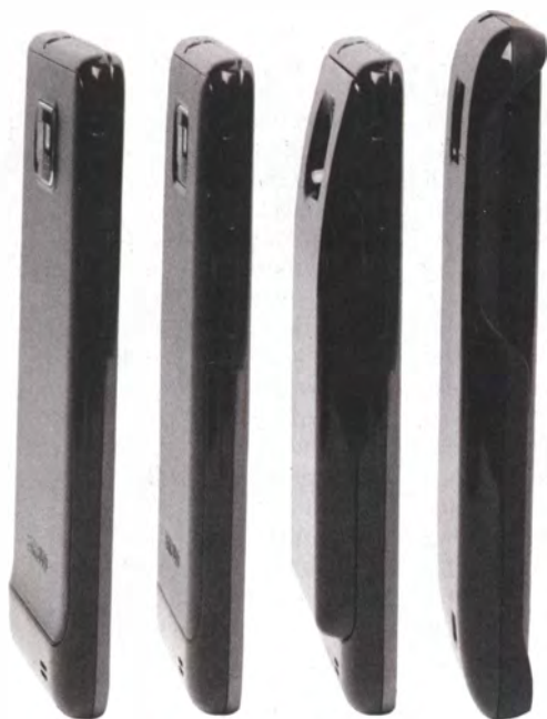
Pimp my Akku: Links das Galaxy S2 mit Original-Akku, daneben mit dem 7,4-Wh-Akku von Samsung. Hinter dem dicken Akkudeckel verbirgt sich der riesige Billig-Akku von Ebay, ganz rechts mit Akku-Case von Samsung.
