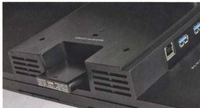
Der Funkempfänger wird in einen Schacht im Monitorgehäuse gesteckt.
