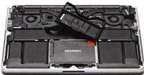
Das SSD-Blade-Modul hängt in einem luftigen Rahmen. An seiner Stelle ist Platz für eine flache 2,5"-SSD.
