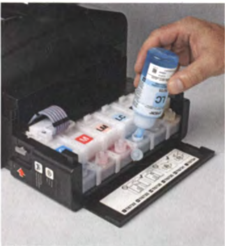
Tanks und Tintenflaschen sind geschickt konstruiert, sodass das Nachfüllen gut von der Hand geht und keine Sauerei verursacht.
