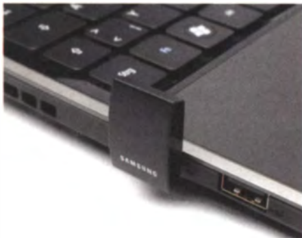
Samsungs WiMedia-Adapter misst gerade einmal 26 mm in der Höhe.
