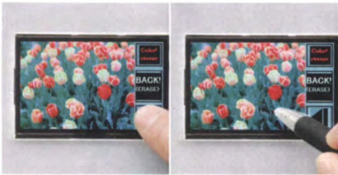
Kleine lichtempfindliche Sensoren neben den Pixeltransistoren erfassen Helligkeitsunterschiede: Der Finger schattet das Backlight ab, mit dem Leuchtstift kann man auf dem Touchscreen schreiben.
