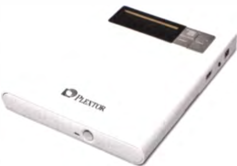
Plextors PX-650US kopiert Discs auch ohne Rechner auf USB-Speicher und SD-Karten, die Einsatzmöglichkeiten mit Android und iOS sind jedoch bescheiden.
