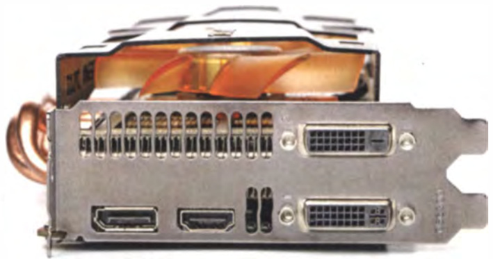
Die GTX-670-Grafikkarten besitzen zwei Dual-Link-DVI-Anschlüsse, eine HDMI-Buchse und einen DisplayPort. Sie können bis zu vier Bildschirme gleichzeitig ansteuern.
