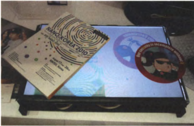
Monitor-Scanner-Kombi von LG: Mit den in die Pixel integrierten Fotodioden kann das Display aufgelegte Vorlagen digitalisieren und sogleich anzeigen.
