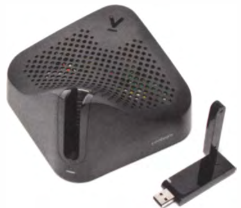
Die Veebeam HD kombiniert UPnP-AV-Technik mit einer USB-Funkbrücke.
