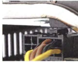
Der Stromstecker lässt sich bei der GTX-670-Variante von Asus nur sehr schwer wieder entfernen.
