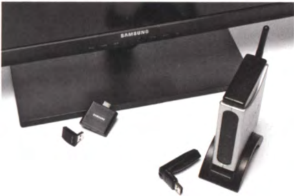
Eine WiMedia-Verbindung im Ultra-Breitband nutzt Samsung bei seinen Smart-Hub-Monitoren. C2G bietet sie als Funkstrecke mit USB-Stick an (rechts).
