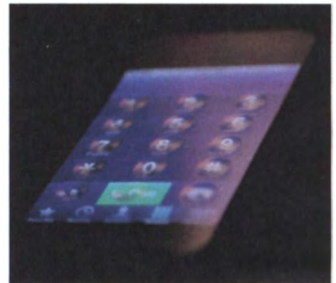
Mit dem Tactile-Layer erzeugt Tactus auf glatten Touchscreens digital reversible Tastaturen.
