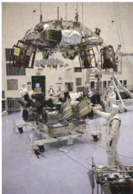
Hier muss alles passen: NASA-Ingenieure beim Zusammenbau des „Sky Crane“. Die Abstiegsstufe (oben im Bild) soll den Rover an Seilen herablassen und dann weiterfliegen.
