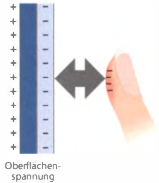
Mit Anziehung oder Abstoßung des Fingers durch elektrostatische Felder erzeugt Senseg auf glatten Touchoberflächen das Gefühl von unterschiedlichen Texturen.
