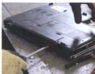
Zerlegung eines recyclingfreundlichen Laptops bei der Elpro Elektronik-Produkt Recycling GmbH: Der Akku, ...
