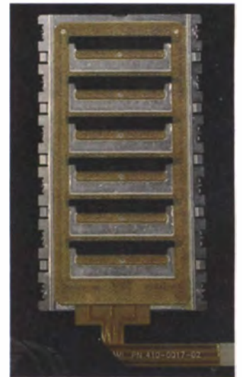
Das fühlbare Feedback an Touchscreens lösen Exzenter-scheiben oder Piezostreifen aus, die bei Berührungen von unten gegen das Deckglas schlagen.
