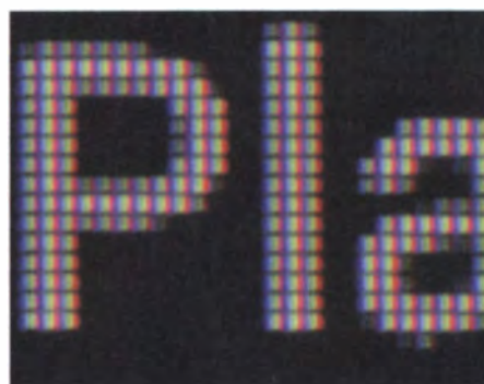
Schrift sieht auf den Full-HD-Displays durch die doppelte Anzahl Pixel auf gleicher Fläche deutlich schärfer aus.
