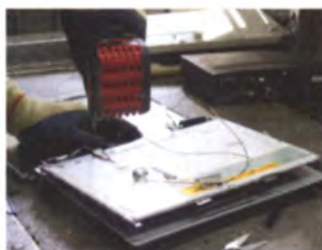
... die Tastatur und das Display mit quecksilberhaltigen Leuchten werden in weniger als einer Minute entfernt.
