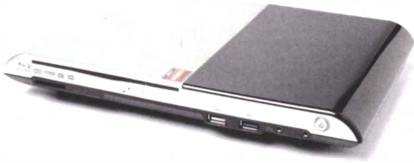
AMDs Kombi-prozessor E-350 steckt beispielsweise in Zotacs ZBox AD03 Plus und gibt dank der integrierten Radeon HD 6310 auch Blu-ray-Filme wieder.
