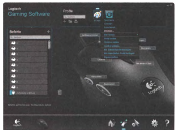
Über die Logitech Gaming Software lassen sich alle Tasten der G400 umbelegen. Wer die Lua-Skriptsprache beherrscht, kann die guten Makrofähigkeiten noch weiter aufbohren.
