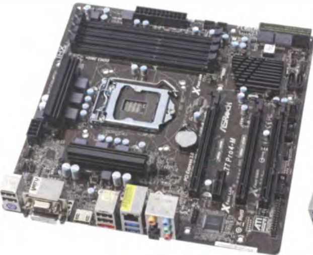
Asrock Z77 Pro4-M: großer Funktionsumfang im kompakten Micro-ATX-Format
