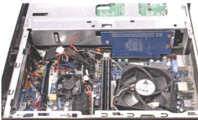
Die Grafikkarte sitzt kopfüber im Gehäuse des Alienware X51 und ist über eine Riser-Card mit dem Mainboard verbunden.
