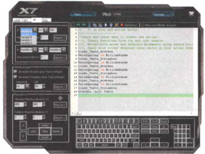
Im Mouse Manager der A4Tech-Mäuse lassen sich sogar Skripte mit Variablen zusammenklicken. Diese Funktionen unterstützt auch die ältere Treiberversion der Sharkoon FireGlider.
