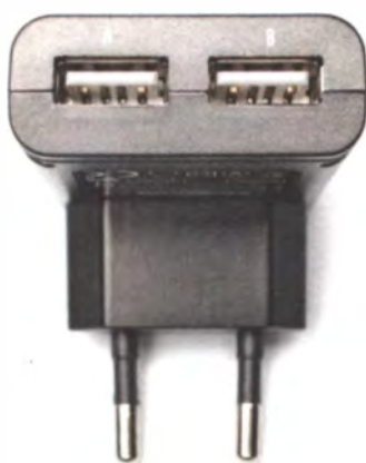
Ansmanns Dual USB Charger besitzt zwei Ausgänge, die für unterschiedliche Geräte vorgesehen sind. Einer versorgt Apple-Geräte und Blackberrys, der andere Handys etwa von Samsung.
