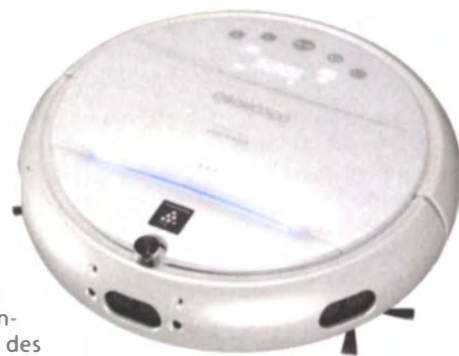
Cocorobo nimmt über die Webcam Bilder auf und überträgt sie per WLAN zum Nutzer.
