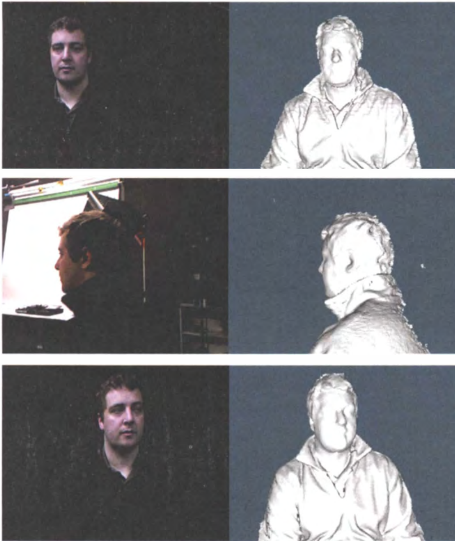
Beim Umkreisen eines Objektes verfeinert ReconstructMe nach und nach das entstehende 3D-Modell (von oben nach unten).
