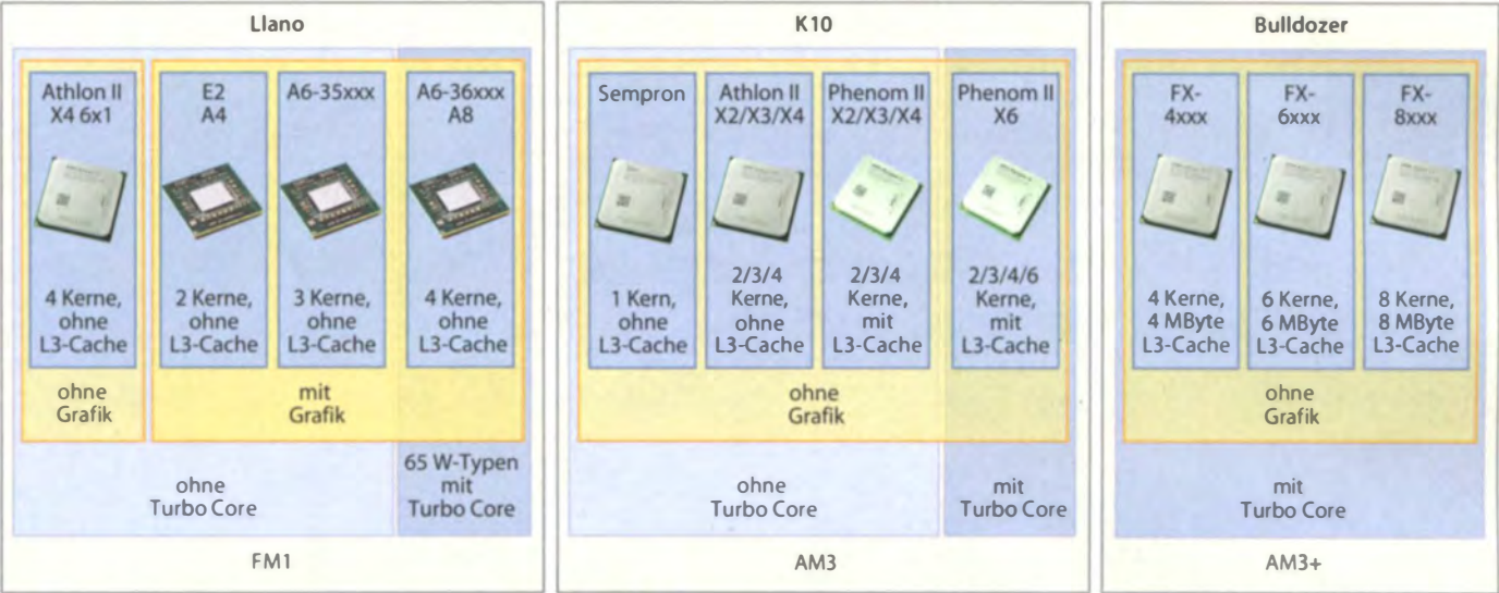
AMD-Prozessoren: Bei FX-Prozessoren zählt AMDs Marketing-Abteilung lieber die Integer-„Kerne“ als die Bulldozer-Module. Die ältere K10-Familie läuft langsam aus, die Zukunft gehört den APUs mit integrierter Grafik.
