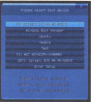
Das zu startende Betriebssystem wählt man über das Boot-Menü der UEFI-Firmware; zum korrekten Aufspielen muss das Installationsmedium unbedingt über UEFI-Funktionen booten.
