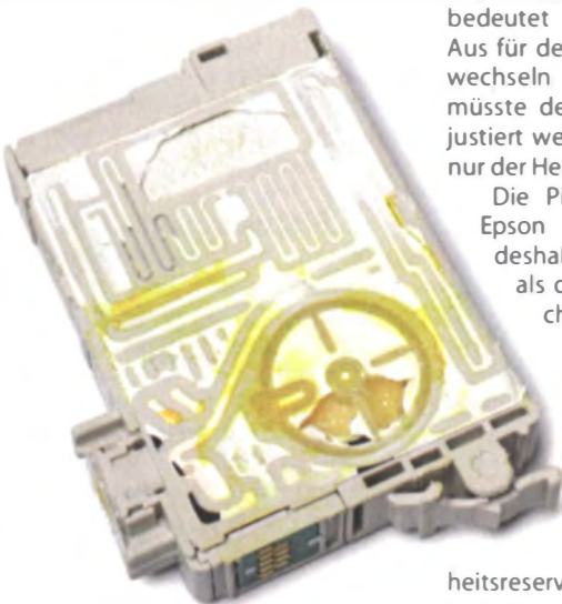
Epson-Patronen sind recht kompliziert aufgebaut und deshalb zum Selbstbefüllen schlecht geeignet.
