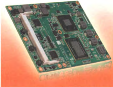
Auf nur 95 mm x 125 mm bringt Congatec beim TM77 einen Ivy-Bridge-Prozessor, den Chipsatz und Arbeitsspeicher unter.
