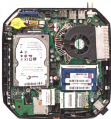
Der DVB-T-Dual-Tuner und das WLAN-Modul belegen die beiden Erweiterungs-Slots im Revo. Als Massenspeicher dient eine Notebook-Platte.
