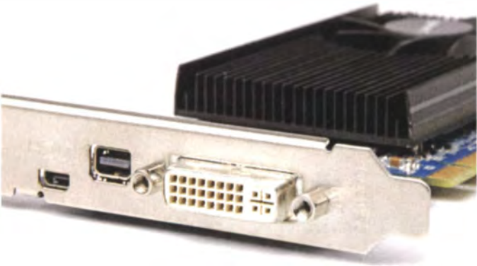
Sapphires Low-Profile-Version der Radeon HD 7750 passt sogar in kompakte Mini-ITX-Gehäuse und bindet bis zu drei Bildschirme gleichzeitig an.
