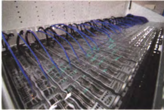
Die texanische Firma Green Revolution Cooling packt Server-Racks in Tanks, um sie mit Mineralöl zu kühlen.
