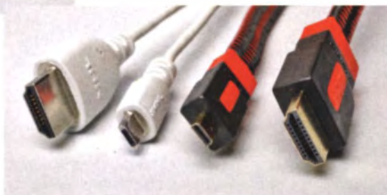
Das rot-schwarze Incipio HD-100 – im Internet als „MHL-Verbindungskabel“ angeboten – ist in Wahrheit ein HDMI-Kabel mit Micro-HDMI-Buchse; daneben das echte MHL-Kabel mit Micro-USB-Anschluss.
