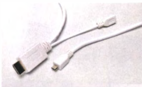
Das rot-schwarze Incipio HD-100 – im Internet als „MHL-Verbindungskabel“ angeboten – ist in Wahrheit ein HDMI-Kabel mit Micro-HDMI-Buchse; daneben das echte MHL-Kabel mit Micro-USB-Anschluss.
