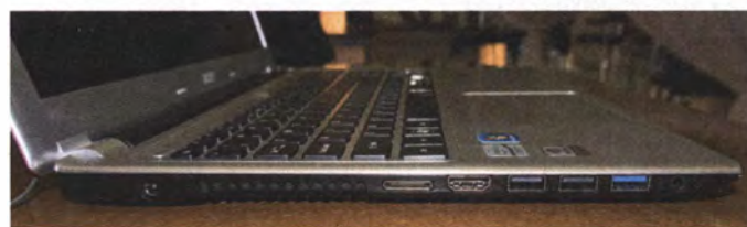
Das Aspire V3 ist so dünn, dass keine normale LAN-Buchse passt, sondern nur eine flachere, proprietäre.
