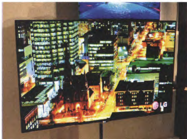
LGs 55-zölliger OLED-Fernseher wird derzeit mit LTPS-Technik gefertigt, künftig will LG IGZO-Transistoren nutzen.
