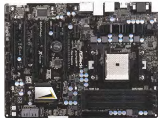
Das Asrock A75 Pro4/MVP unterstützt die beiden Hybridgrafik-Techniken AMD Dual Graphics und Lucid Logix Virtu MVP.
