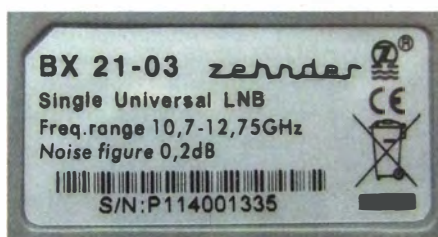
Typenschild eines digitaltauglichen LNB: Der Frequenzbereich reicht von 10,7 bis 12,75 GHz.
