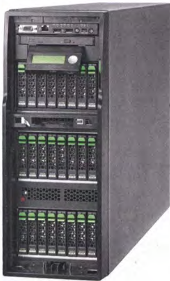
Fujitsu Primergy TX300 S7: Server im klassischen Tower-Gewand für zwei Xeons, zwei Tesla-Beschleuniger sowie je 24 Speichermodule und 2,5-Zoll-Platten.
