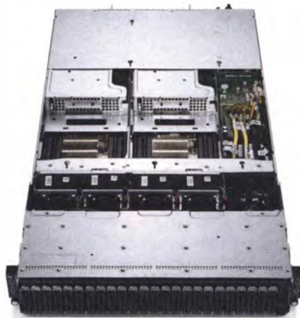
Dell PowerEdge C6220: vier Half-Node-Boards und 24 Platten in einem gemeinsamen 2-HE-Chassis.
