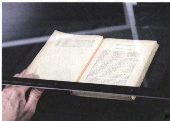
Eine Lasermarkierung hilft sehr elegant bei der Positionierung des Buches, man kann sich aber auch anders behelfen, etwa mit einer Leiste für den Anschlag.
