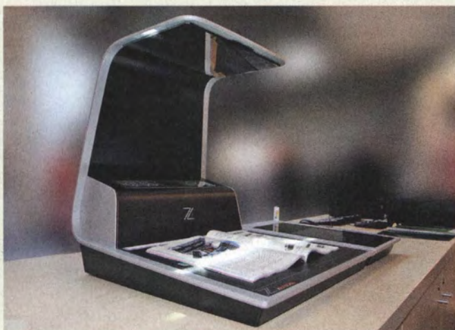
Der Profi-Buchscanner Zeta von Zeutschel tastet die Vorlage über einen Spiegel von oben ab.
